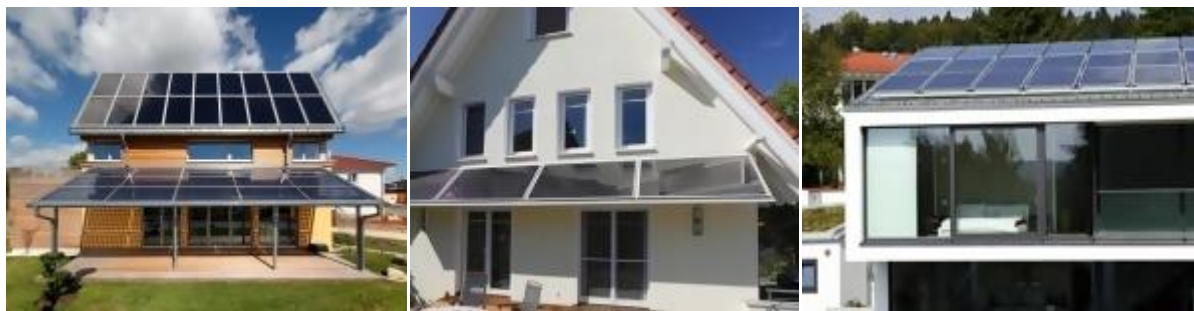
Слика 18. Интегрисани и неинтегрисани соларни колектори на косим и равним површинама[19]
