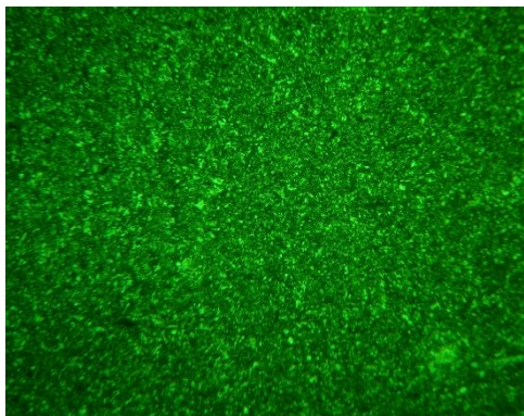
Слика 5.17 Основни материјал Hardox 450 (200x) Међуфазна структура побољшања
