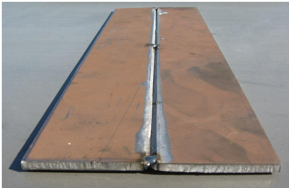
Слика 6.7 Узорак 1 – димензије плоча, облик и димензије жлеба са редоследом извођења пролаза
