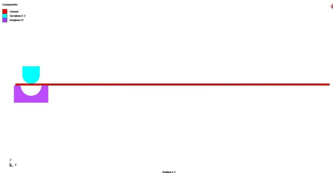
Слика 5.23. Приказ алата и дискретизованог припремка у YZ равни пре почетка симулације процеса савијања прве зоне
