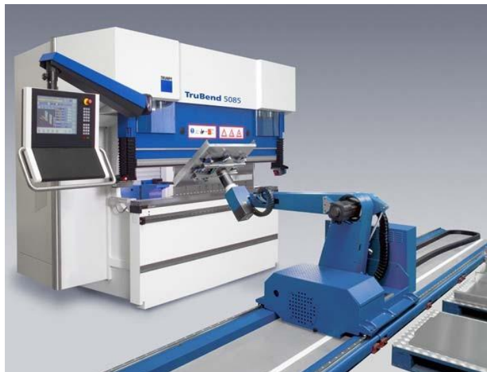
Слика 3.6. Хидраулична апкант преса са роботом за манипулацију обратком [9]
