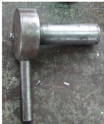
Сл. 12 – Кружношетајући осигурач на наличју подеоне плоче
