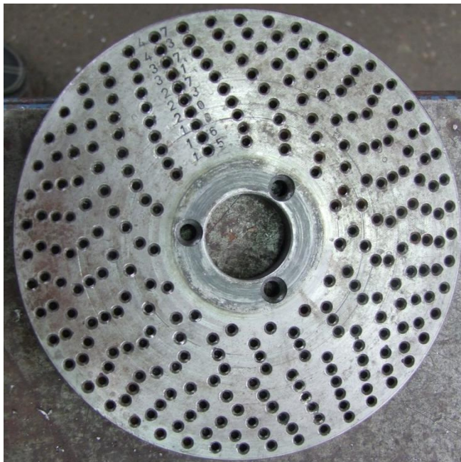
Сл. 6 – Подеона плоча универзалног подеоног апарата
