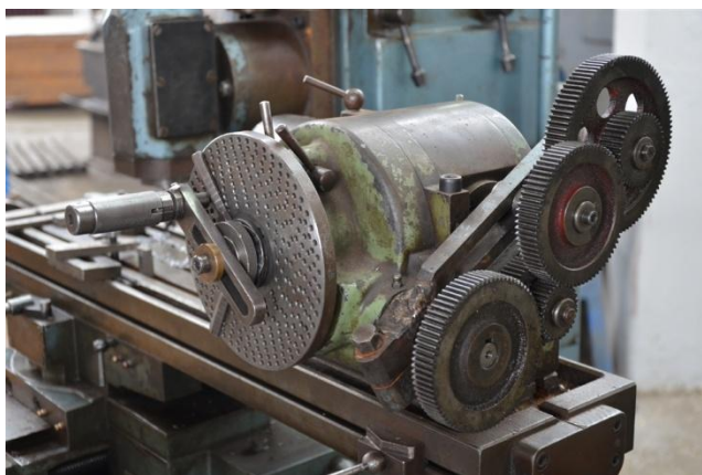
Сл. 15 – Подеони апарат са малом гитаром и променљивим зупчаницима, спреман за диференцијалну поделу
