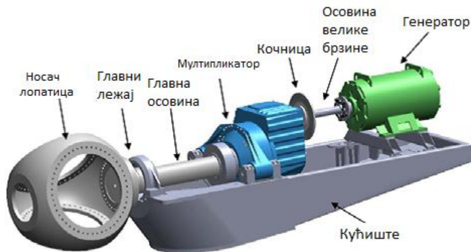
Слика 3. Конфигурација модуларног погонског склопа [3]
