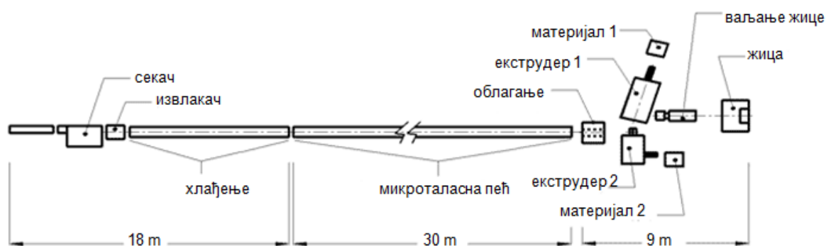
Слика 21. Линеја процеса за облагање жице [18].
