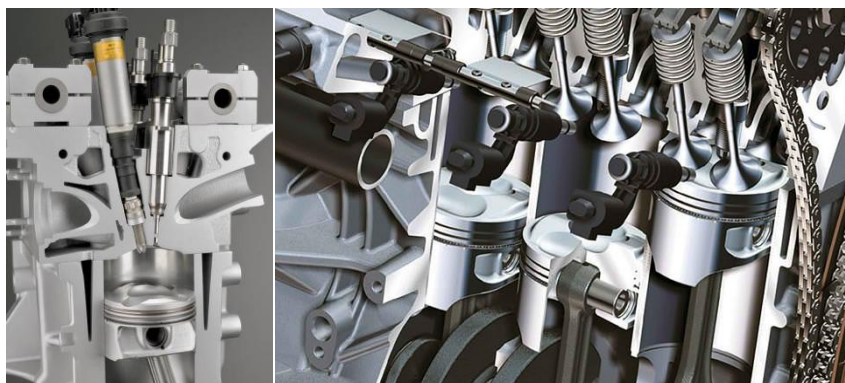
Слика 6.2 – Лево – пресек BMW – овог ото мотора; Десно – Volkswagen FSI ото мотор [9] [10]
