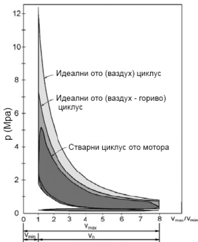
Слика 2.6 – Разлике између идеалног и реалног ото циклуса [7]
