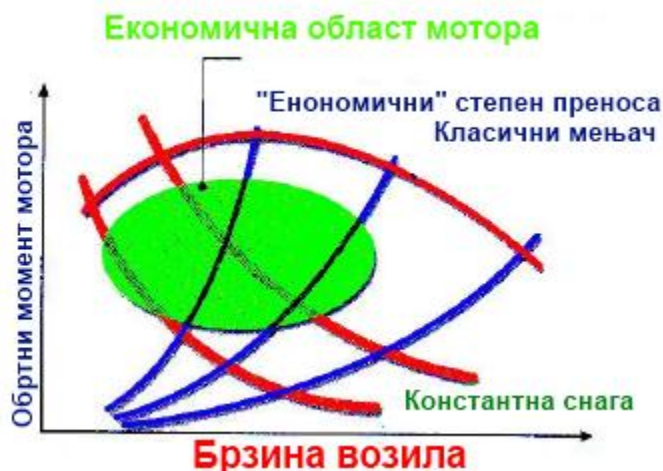
Слика 2.8 – Дијаграмски приказ области у којима је потрошња горива код савремених ото мотора мала [8]
