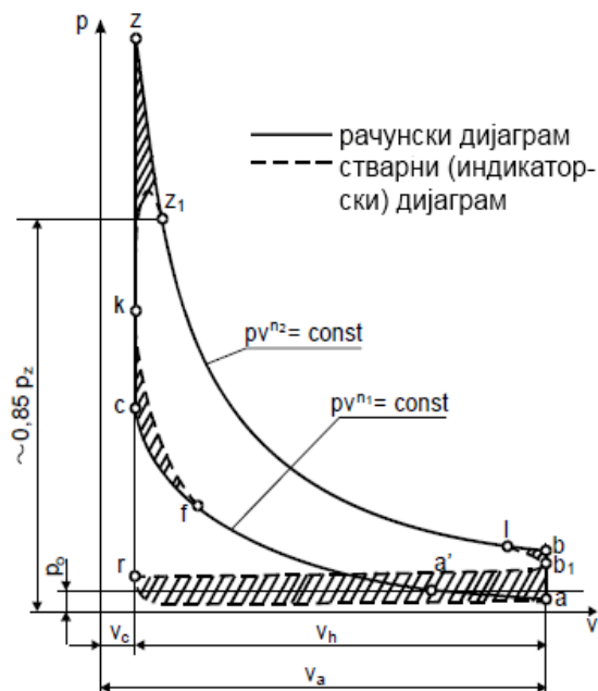
Слика 4.1 – Прорачунски и индикаторски дијаграм четворотактног ото мотора [1]
