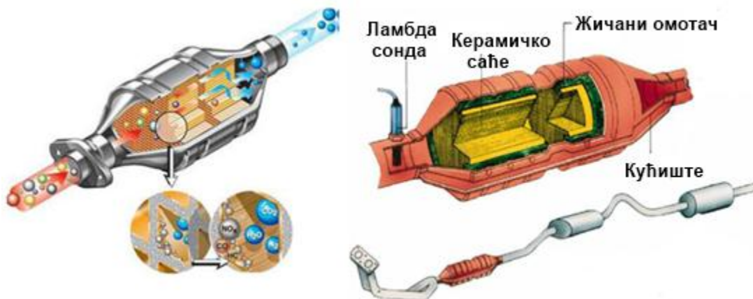
Слика 2.14 – Стандардни једноструки (трокомпонентни) катализатор [3]
