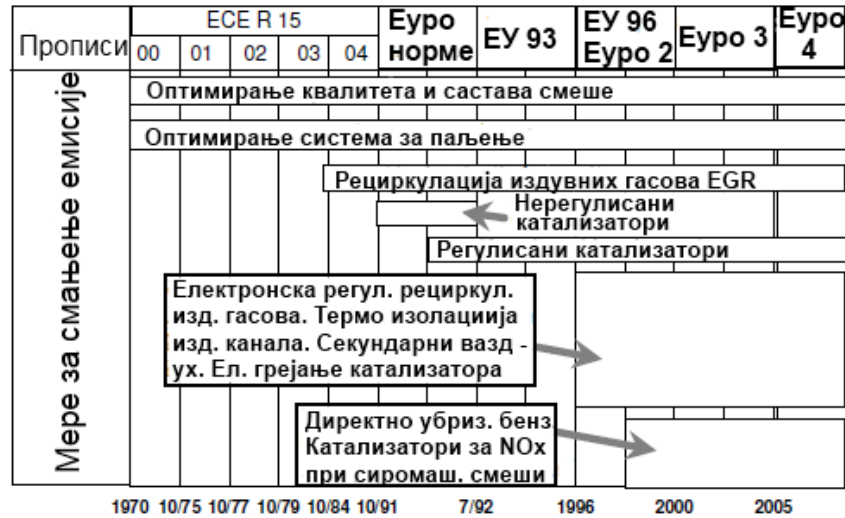
Слика 2.13 – Развој опреме ото мотора до Еуро 4 стандарда (2005. год.) [3]
