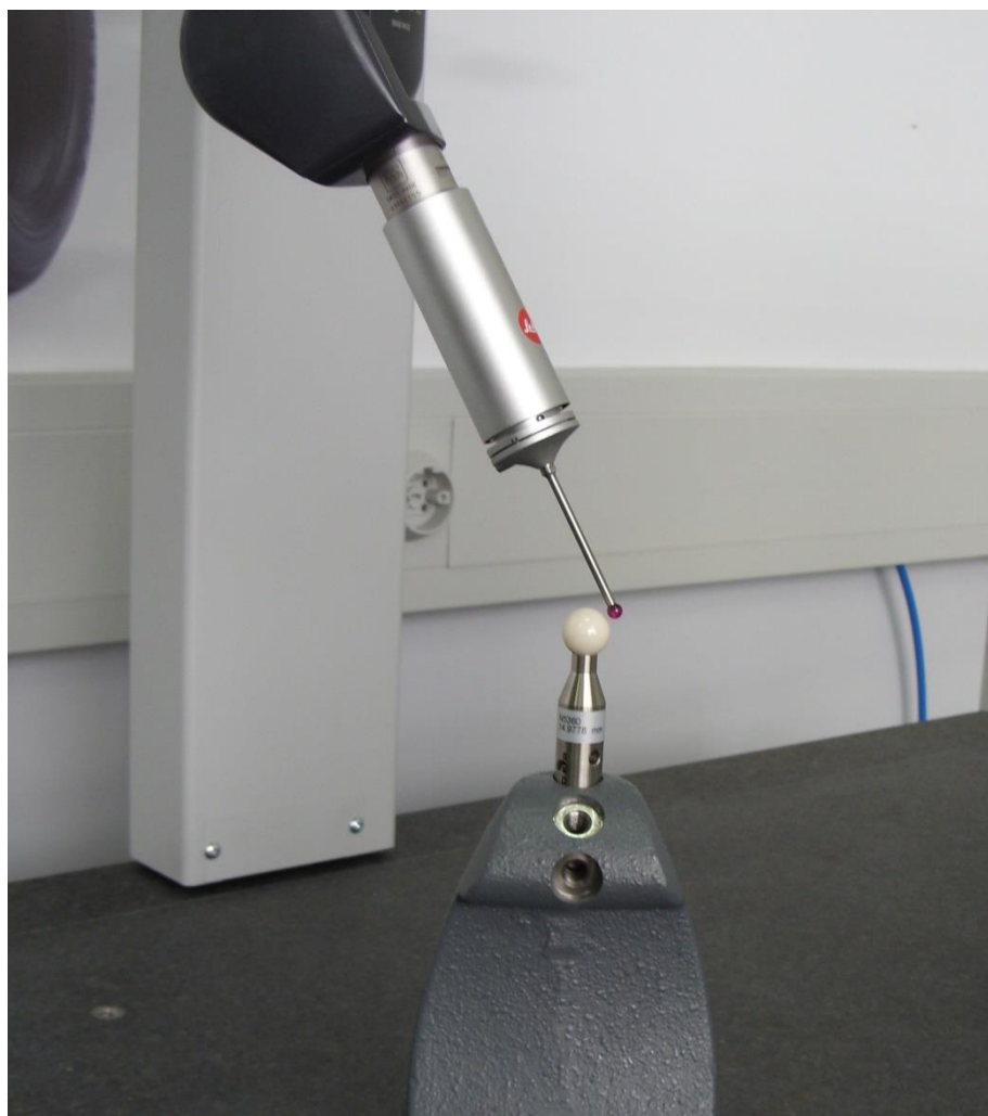
Слика 13. Сфера за калибрацију мерног пипка
