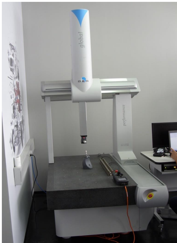
Слика 1. Фотографија савремене нумерички управљане мерне машине
