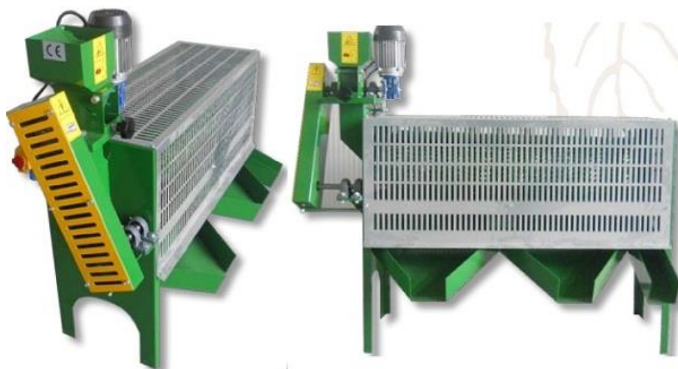
Слика 25. Одвајање љуске од језгра [12]
