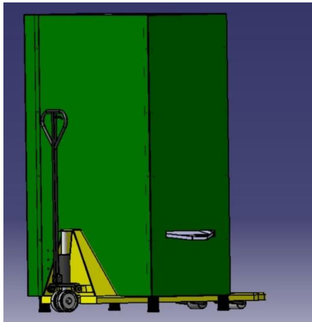
Слика 83. Пренос машине палетаром
