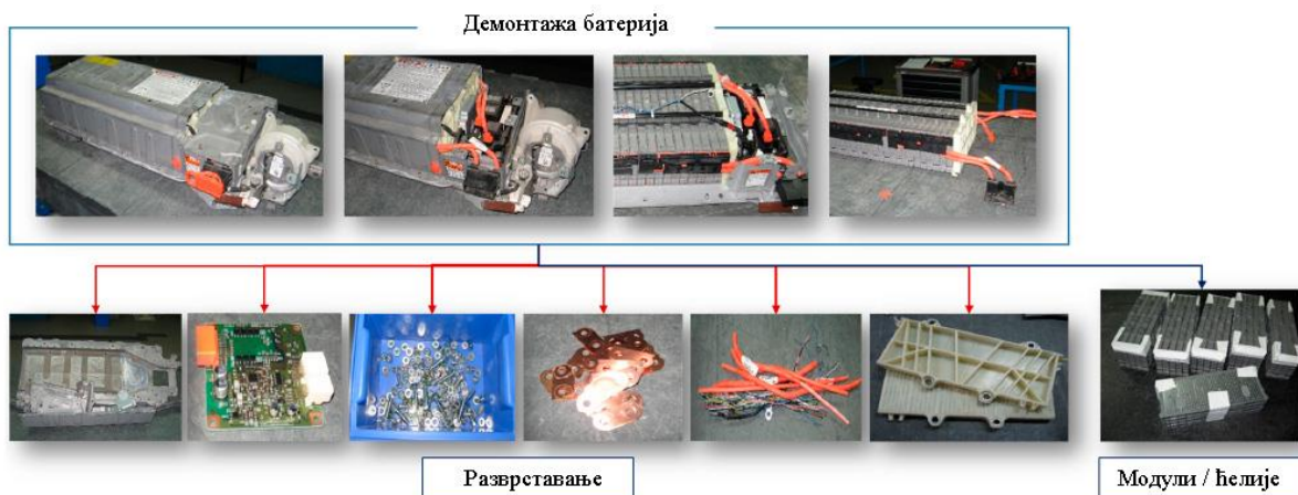
Слика 9. Поступак демонтаже батерија хибридних и возила на електрични погон на саставне делове
