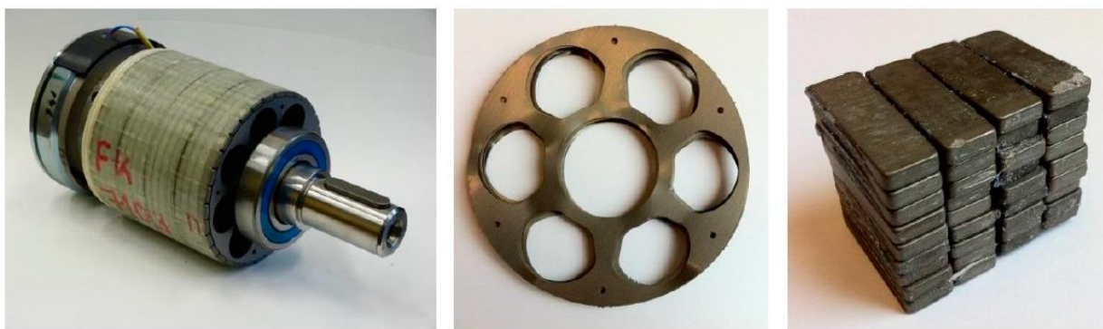
Слика 13. Ротор, сегмент ротора и демонтирани магнети (који се монтирају на површини)
