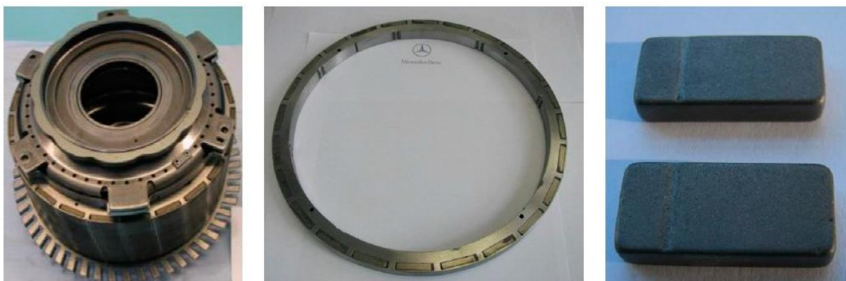
Слика 14. Ротор, сегмент ротора и демонтирани магнети (који су интегрисани)
