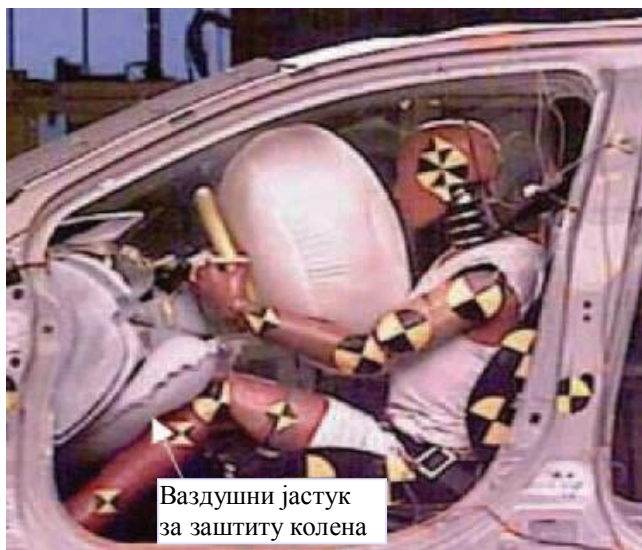
Слика 4.20 – Положај ваздушног јастука за заштиту колена, [23]
