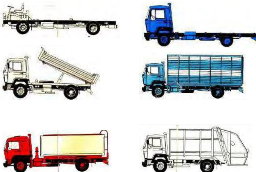
Слика 3.5 - Различите надградње на истом шасијском раму савременог теретног возила
