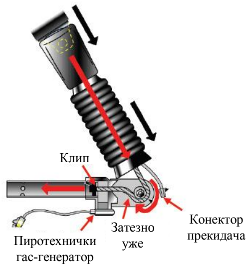
б) принцип затезања појаса пиротехничким предзатезачем
