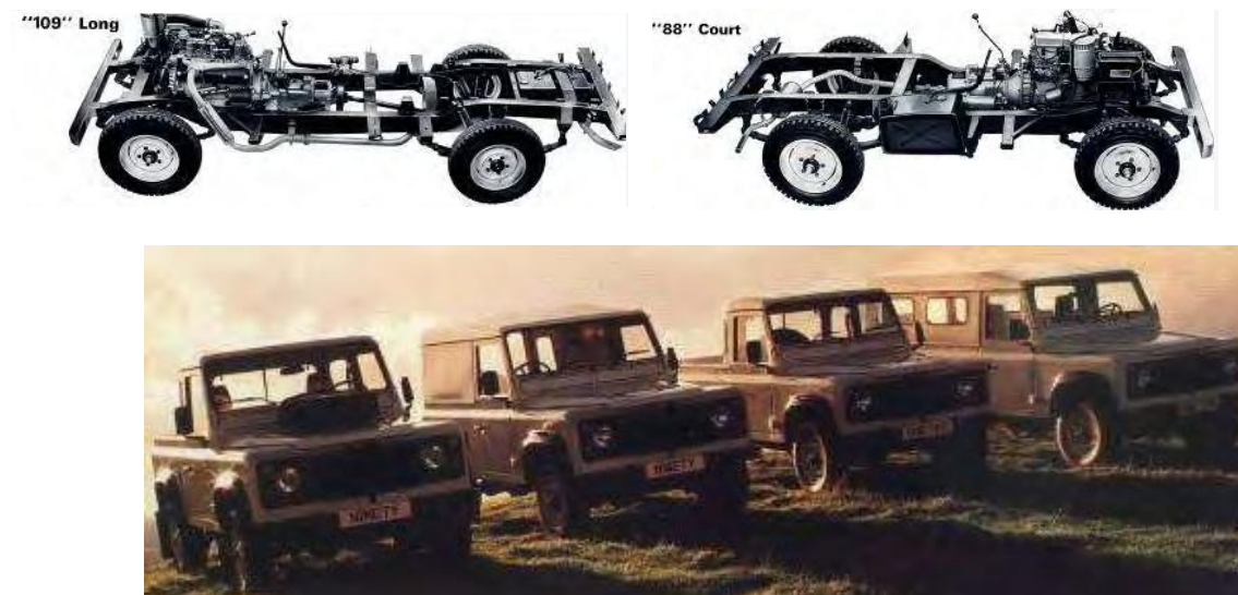
Слика 3.7 - Каросерија са делимично интегрисаним шасијским рамом Ланд Ровер, [2]
