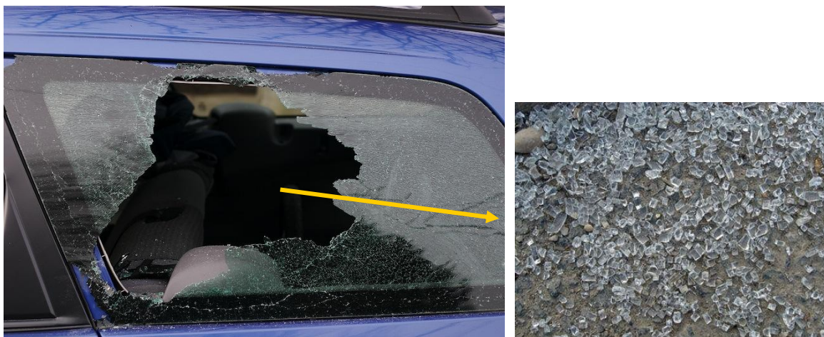
Слика 5.5 – Каљено сигурносно стакло након ломљења, [30]
