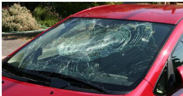
Слика 5.4 – Слојевито сигурносно стакло после удара, [28]
