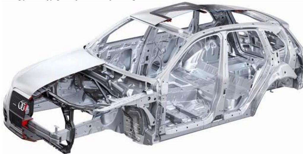
Слика 3.10 - Пример носеће структуре каросерије (Audi Q5), [5]
