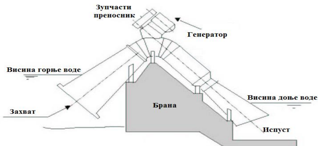
Слика 11. Нископритисна хидроелектрана са сифонским доводом [8]
