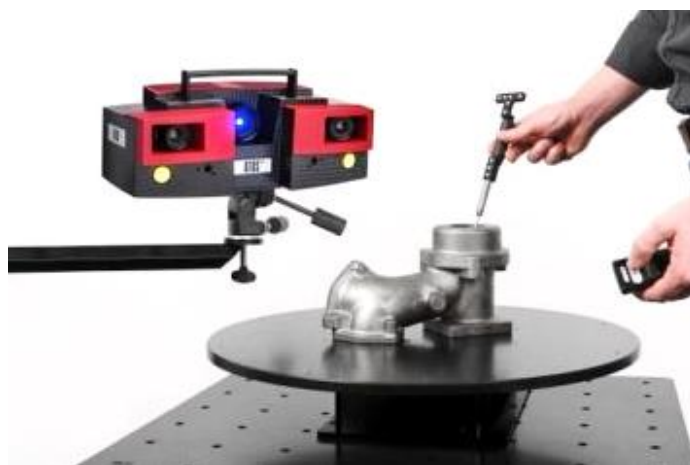
Слика 3.23 Комбинација бесконтакног ATOS 3D скенера и контактне мерне сонде [40]
