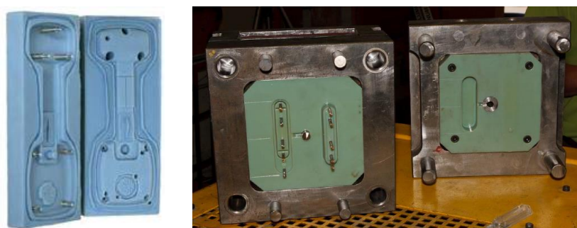
Слика 2.23 Калупи за ињекционо брызгање израђени SLA-Direct AIM поступком [18]
