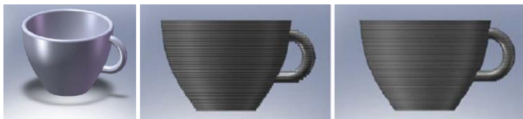
Слика 2.3 CAD слика шоље за чај са додатним сликама које показују ефекте изградње користећи различите дебљине слоја [10]
