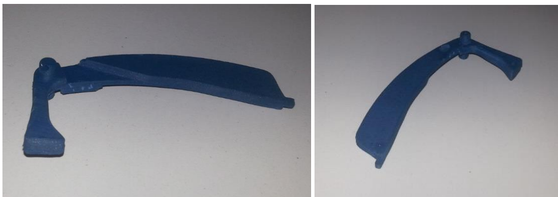
Слика 7.6 Коначан изглед одливка након вађења из калупа и уклањања вишка материјала
