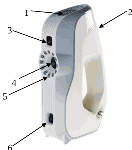
Слика 3.15 3D скенер ArtecEva Lite (ЦЕВИП): 1 – вентилационе рупе, 2 – дугме за преглед/снимање и заустављање, 3 – флеш лампа за 3D снимање, 4 – камера, 5 – 12 LED флеш лампи, 6 – 3D камера [30]
