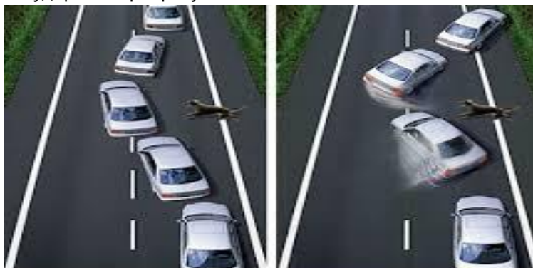
Слика 4.11. Понашање возила са ABS-ом (лево) и понашање возила без ABS-а (десно) 20
