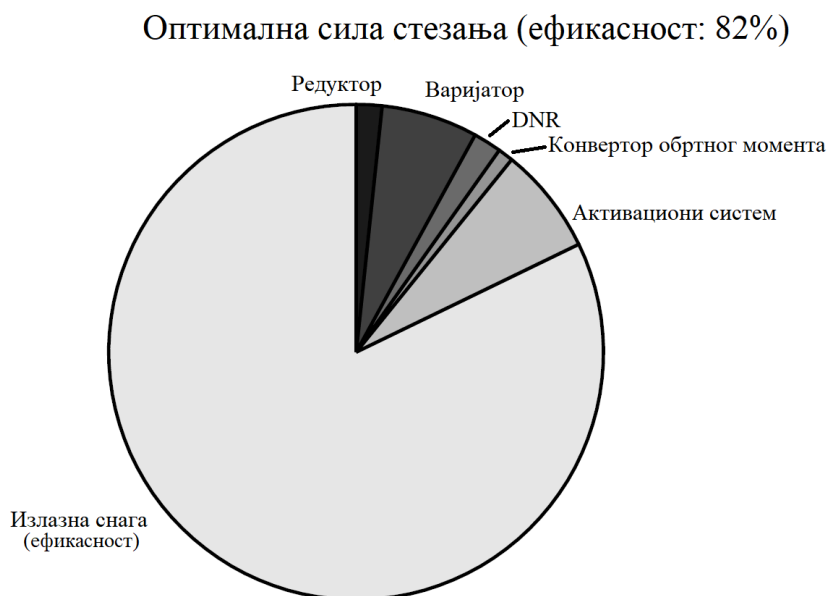
Слика 27 – Проток снаге мотора у CVT-у са оптималном силом стезања [4]
