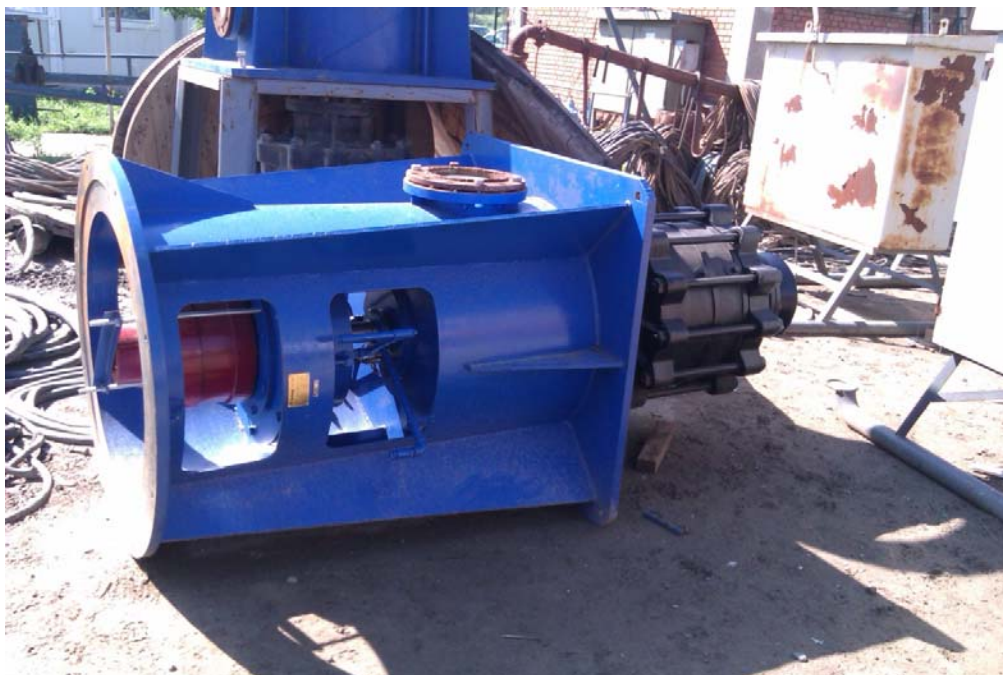
Сл 5.2.Пумпни агрегат BPV 8 – 3
