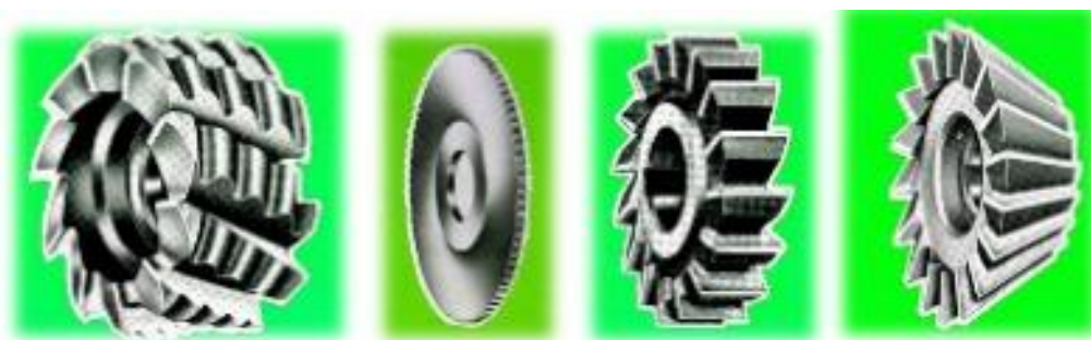
Слика 2.10. Глодала са начином постављања насадна [7]
