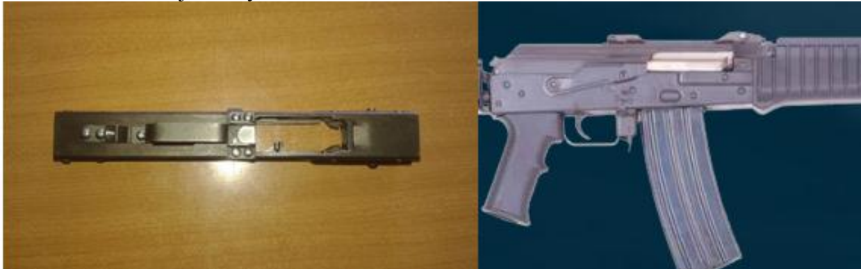
Слика 3.34. Сандук оружја фабрике "Застава оружје" АП М21 услед технологије обраде деформацијом [3]
