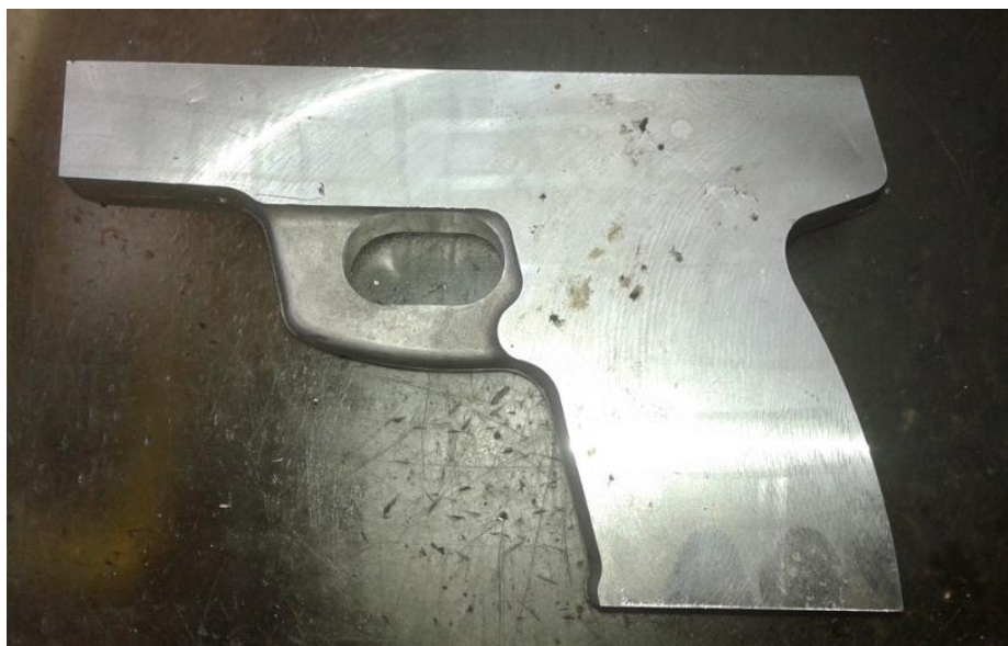
Слика 3.20. Полуфабрикат оружја фабрике "Застава оружје", пиштољ CZ 999 [3]
