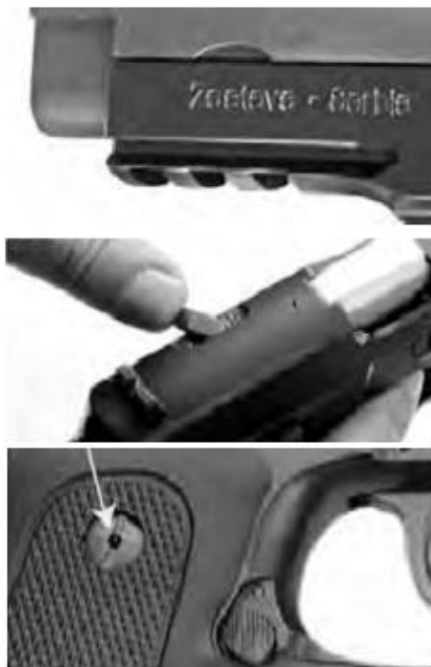
Слика 3.17. - Селектор мода (горе) и показивач последња три метка у цеви (доле) [13]
