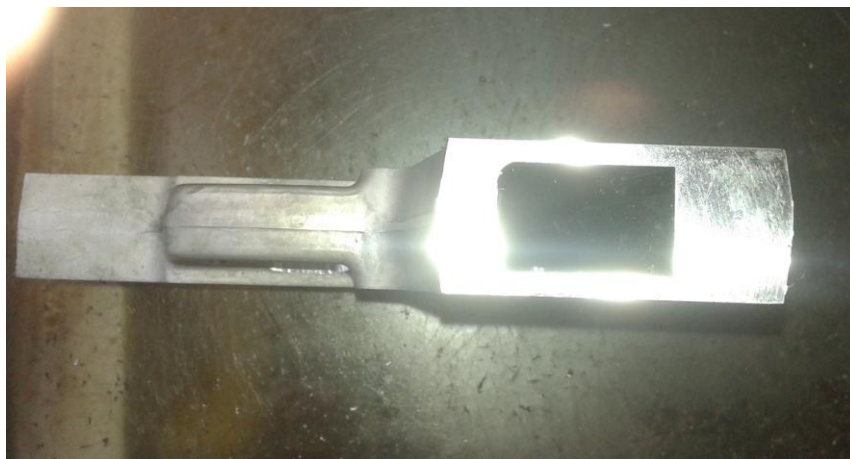
Слика 3.21. Отвор магацина оружја фабрике "Застава оружје", пиштољ CZ 999 након унутрашњег провлачења и глодањем бока ивица [3]
