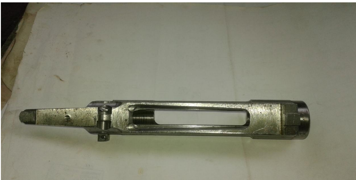
Слика 3.26. Отвор сандука оружја ловачког карабина М70 фабрике "Застава оружје" [3]
