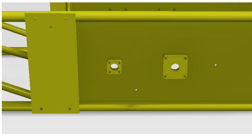
Слика 7.3. Челичне плоче, бочни лим и кућишта лежајева погонског добоша
