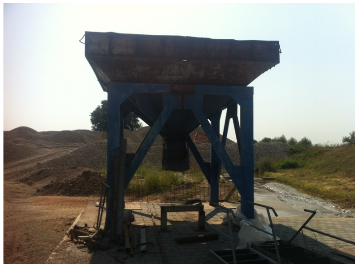
Слика 5.5. Усипни левак монтиран недалеко од дробиличног постројења [13]
