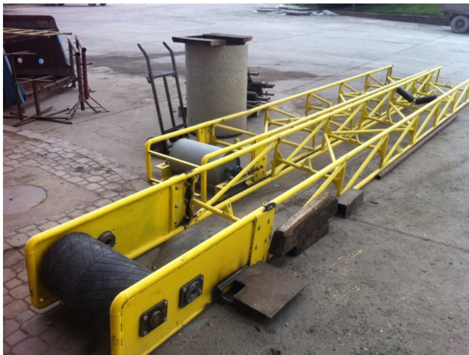
Слика 8.7. Конструкција тракастог транспортера [13]
