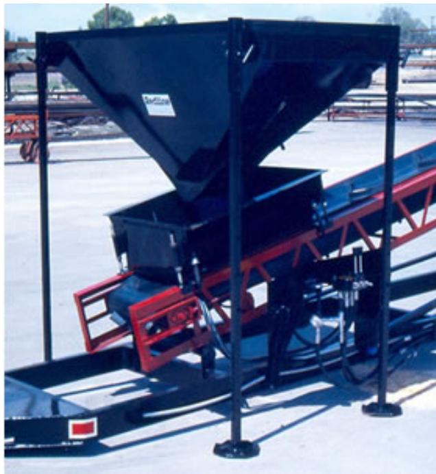
Слика 3.7. Утоварни левак тракастог транспортера [10]
