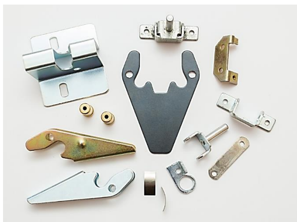
Слика 2.1. Делови добијени обрадом метала деформисањем [6]
