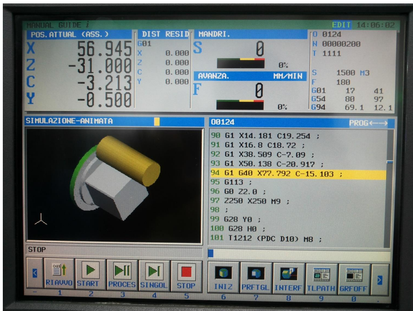
Слика 12 – Приказ симулације са параметрима и NC кодом
