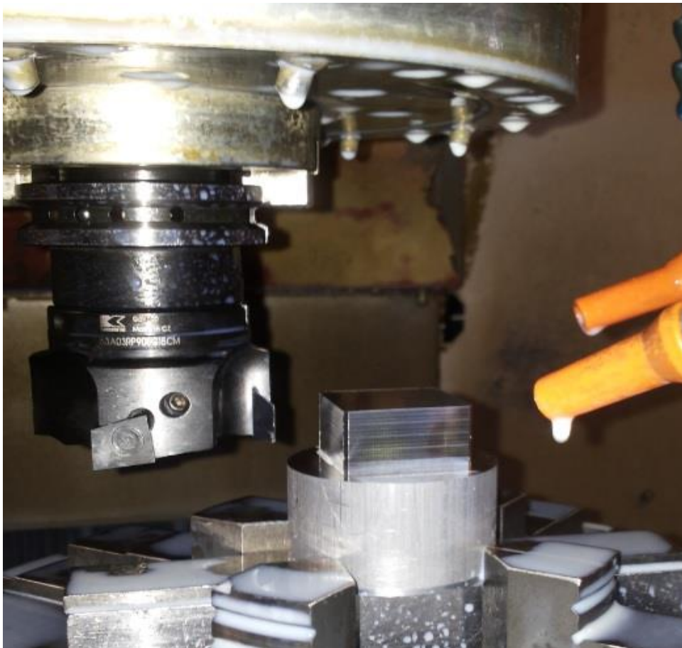
Слика 21 – Равнање и добијање контуре обрадом глодањем
