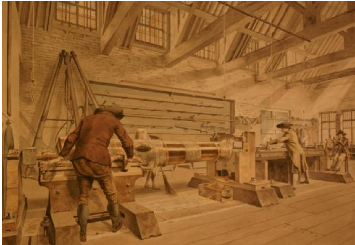
Слика 2 - Хоризонтална бушилица у Вулвичу као претеча хоризонталног струга [2]
