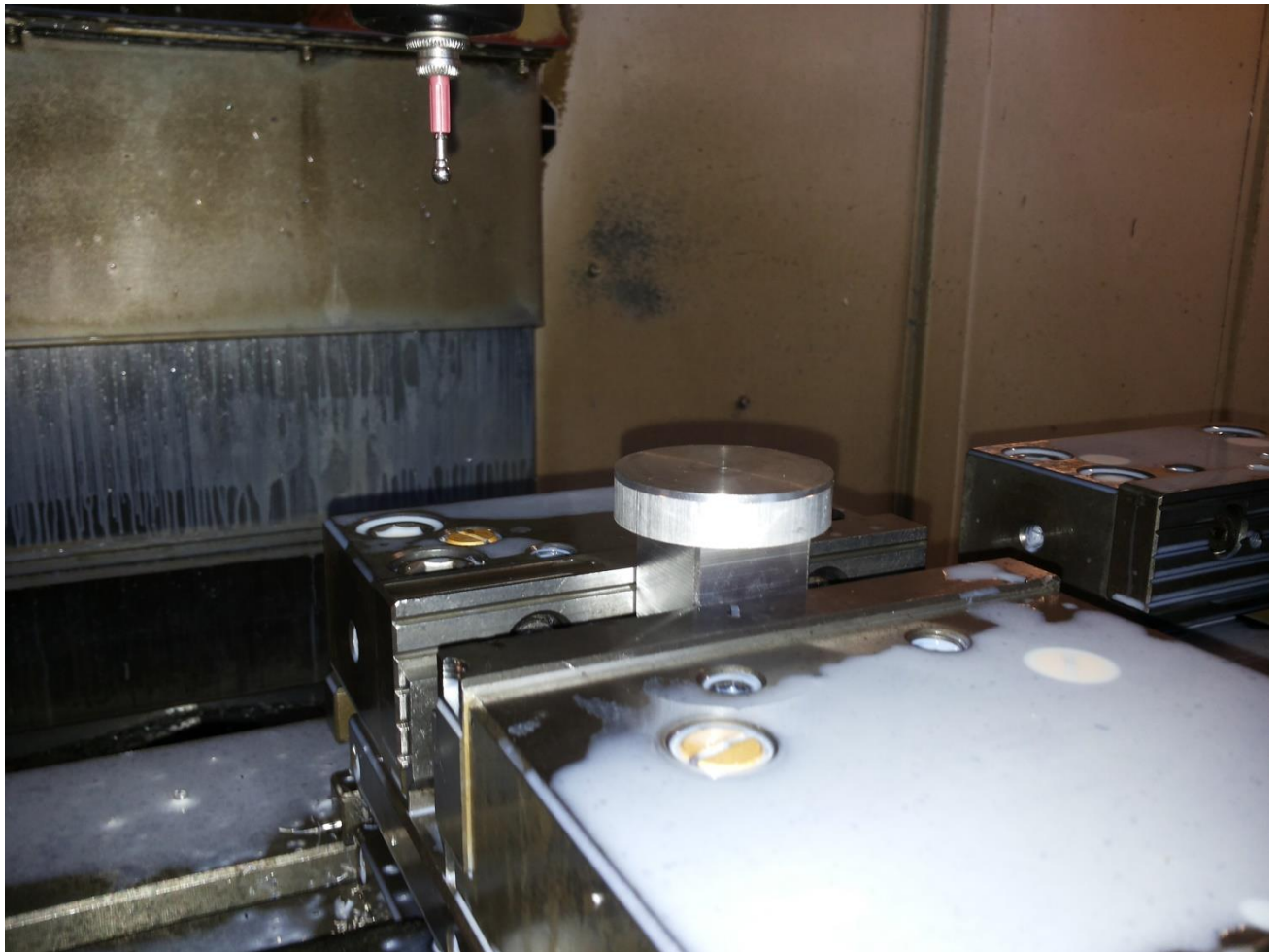
Слика 25 – Предмет обраде стегнут у машинској паралелној стези (припрема за другу фазу)
