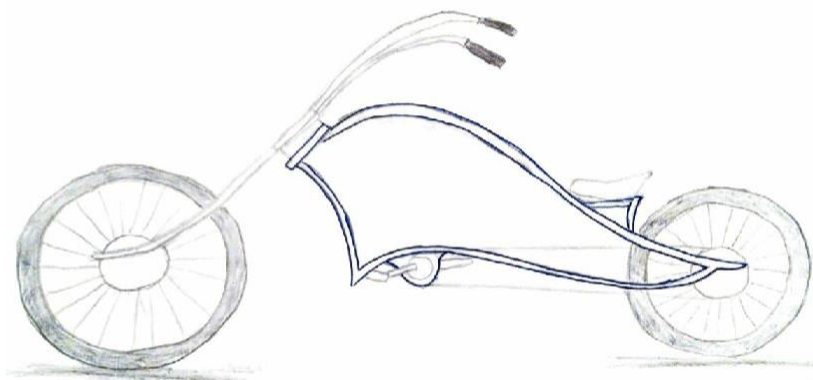
Слика 22 – Првобитно идејно решење рама
