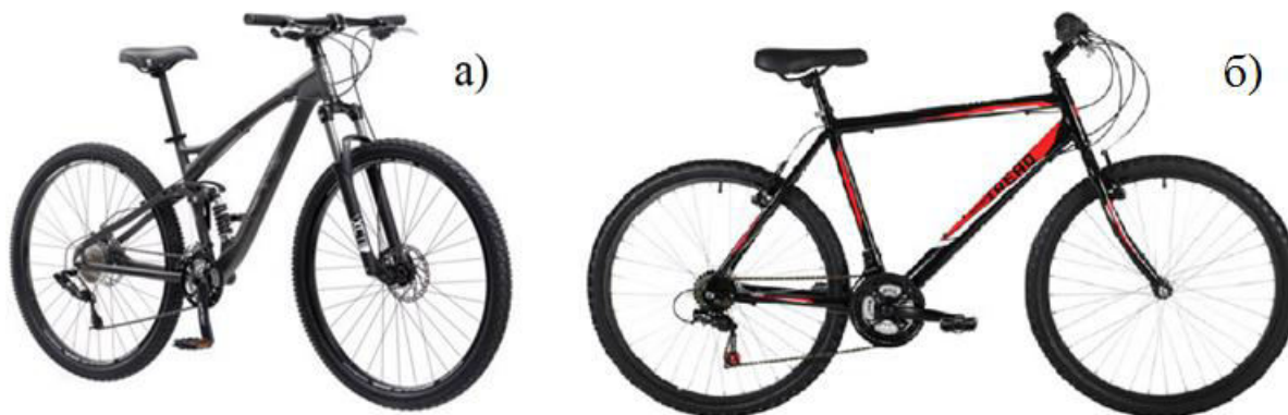
Слика 9 – Модели брдског бицикла а) са амортизерима, б) без амортизера
