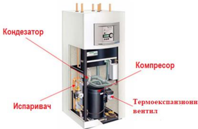
Слика 20. Основни делови компресорске топлотне пумпе [1]
