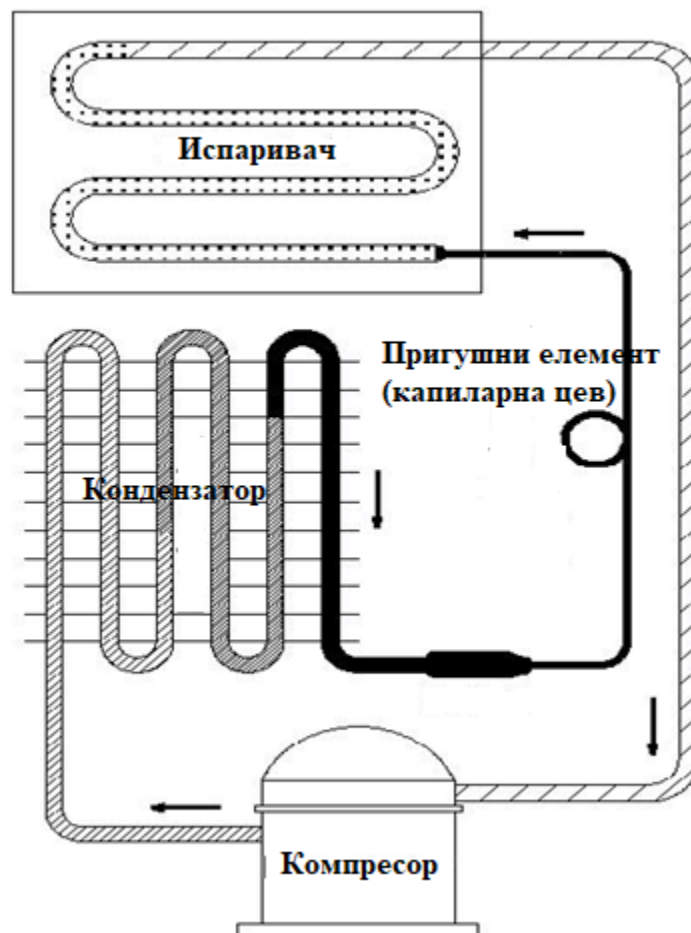
Слика 17. Шема постројења компресорског парног циклуса
