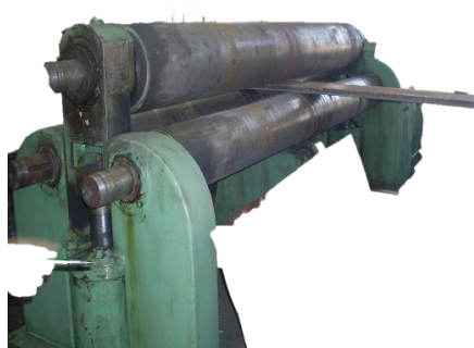
Слика_4.9 а) Машина за савијање челичних трака; б) савијена трака за кочницу витла
