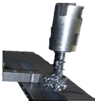
Слика_4.8 Израда отвора а) Борвел машина, б) на стубној бушилици
