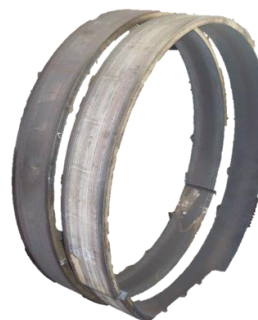
Слика_4.9 а) Машина за савијање челичних трака; б) савијена трака за кочницу витла
