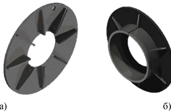
Слика_3.5 а) друга бочна страна и б) бочна страна са добошем кочнице [16]
