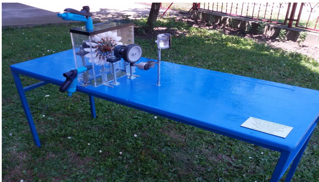
Слика 58 Приказ лабораторијског модела МХЕ са Пелтоновом турбином
