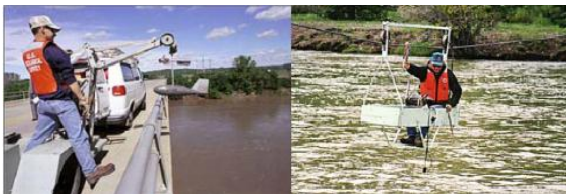
Слика 53 Начини мерења са моста и жичаре [33]
