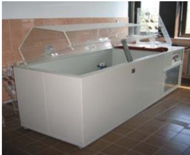
Слика 4. Изглед коморе за испитивање методом слане магле [6]
