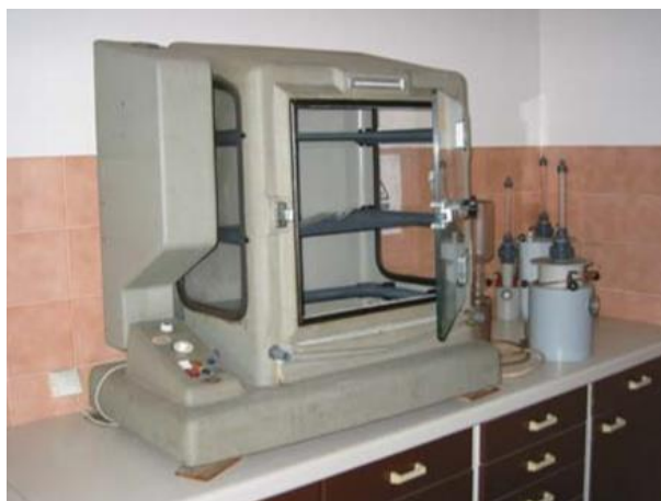
Слика 5. Изглед коморе за испитивање по методи \text{SO}_2 и \text{CO}_2 [6]
