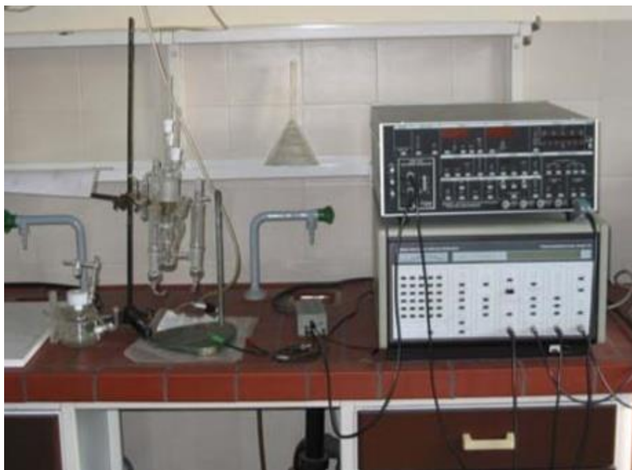
Слика 7. Систем за електрохемијска корозиона мерења [6]
