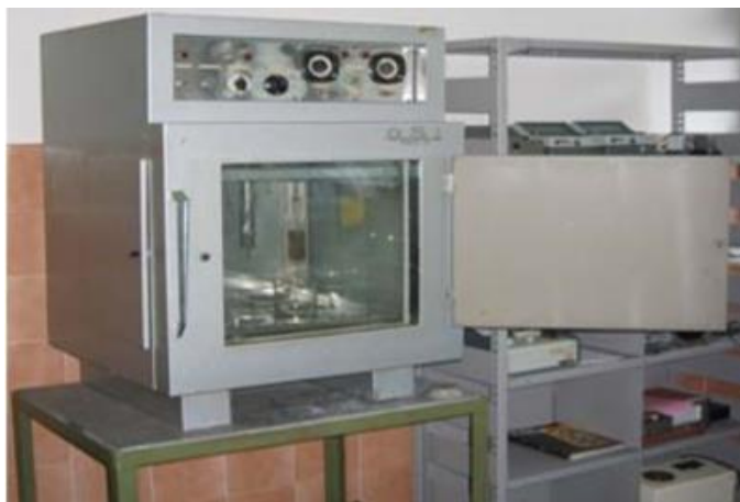
Слика 6. Уређај за испитивање корозије наизменичним урањањем [6]
