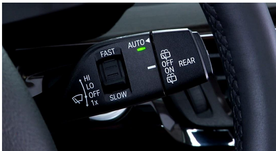
Слика 10 – Прекидач за управљање брисачима [16]
