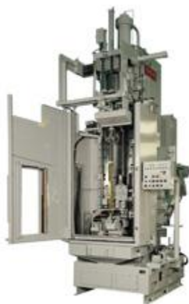
Слика 3.7 Тип провлакачице са покретним предметом обраде [11]
