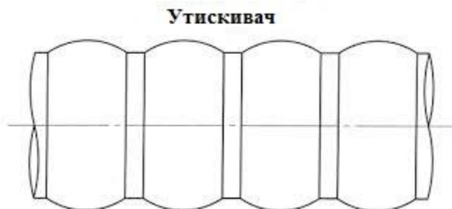
Слика 2.4 Шема алата за обраду утискивањем
