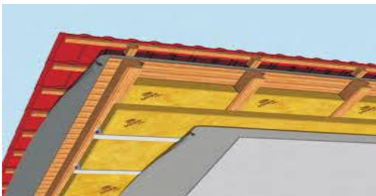
Слика 18. Пример изолације крова
