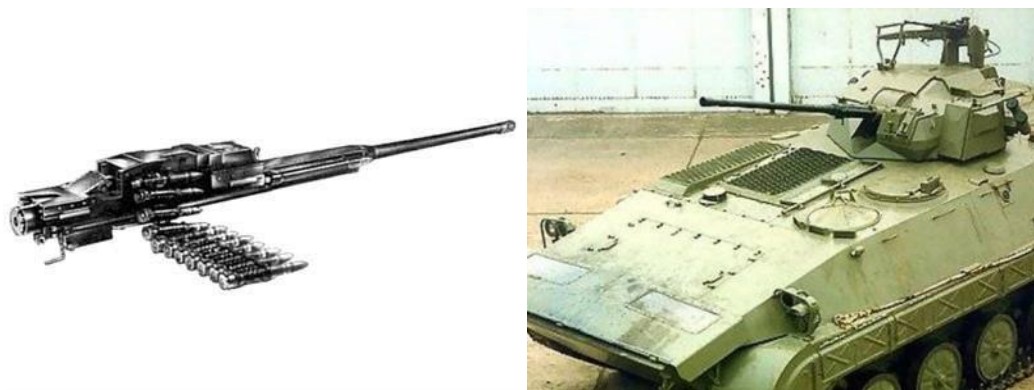
Слика 3.60. Аутоматски топ 30 mm М86 (лево), монтиран у куполи борбеног возила пешадије М98А „Видра“ (десно)
