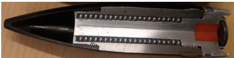
Слика 2.7. Пресек пробојно-парчадног пројектила [11]
