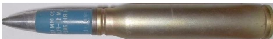
Слика 3.24. Изглед вежбовног метка 20 mm са лажним упаљачем [27]
