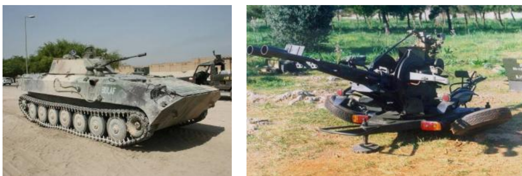
Слика 3.27. Аутоматски топ 23 mm 2A14 на БМП-23 (лево) и двоцевни противавионски топ 23 mm ЗУ-23-2 „Сергеј“ (десно)
