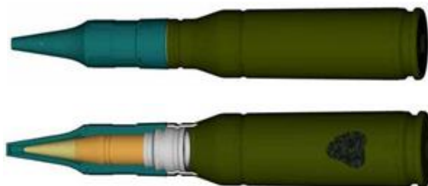
Слика 3.39. Спољни изглед (горе) и пресек вежбовног метка 25 mm са ПКО пројектилом M910 (доле) [32]
