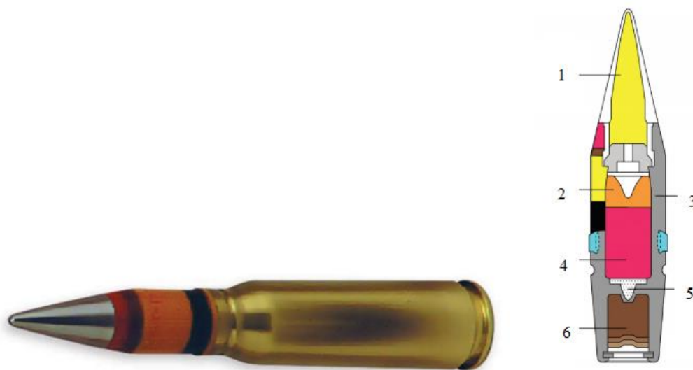
Слика 3.7. Спољни изглед метка (лево) и изглед пресека вишенаменског пројектила 20 mm M940 (десно). [22]
