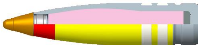
Слика 2.8. Пресек разорног пројектила 30 mm PGU-13/B HEI [12]
