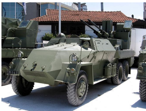
Слика 3.54. Самоходни противавионски топ 30/2 mm M53/59 „Прага“
