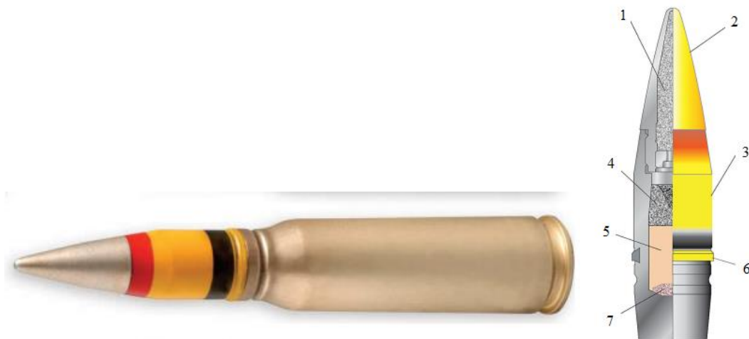
Слика 3.5. Спољни изглед метка (лево) и изглед пресека пробојно-трнутно-запаљивог пројектила 20 mm PGU-28A/B (desno). [20]
