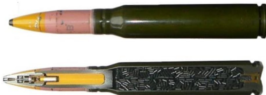
Слика 3.19. Спољни изглед (горе) и изглед пресека метка 20 mm са тренутно-запаљивим пројектилом (доле). [27]
