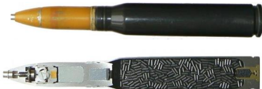
Слика 3.21. Спољни изглед (горе) и изглед пресека метка 20 mm са тренутно-запаљиво-обележавајућим пројектилом M599 (доле). [27]
