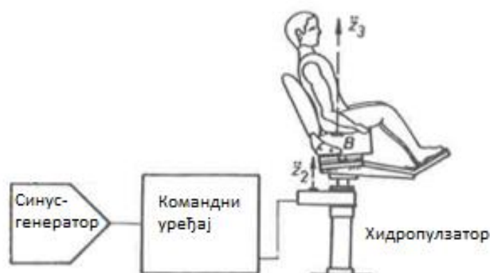
Слика 20: Блок шема за испитивање система човек – седиште [3]
