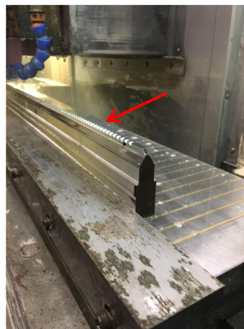
Слика 4.29. Фотографски приказ степеновања провлакача
