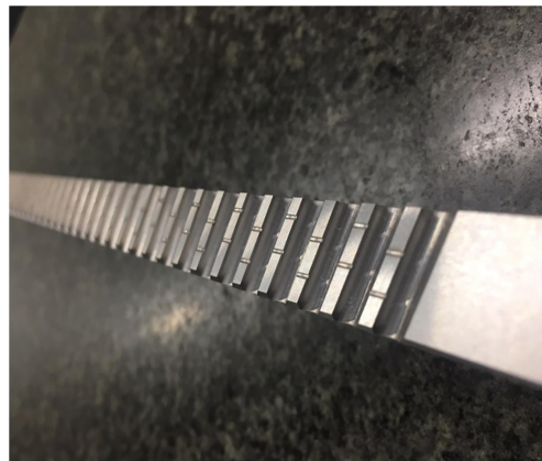
Слика 2.10. Фотографски приказ ломача на призматичном провлакачу
