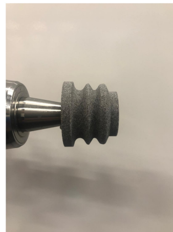
Слика 4.41. Тоцило за израду „cristmas tree“ профила (Ø30)-хинтеровање
