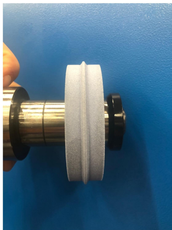
Слика 4.40. Тоцило за израду еволвентног профила (Ø80)
