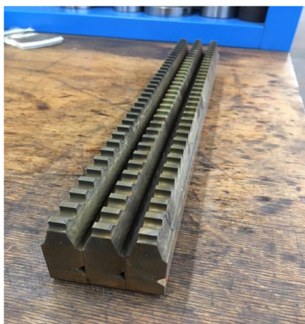
Слика 4.24. Фотографски приказ истовремено ерозираних зуба на призматичним провлакачима
