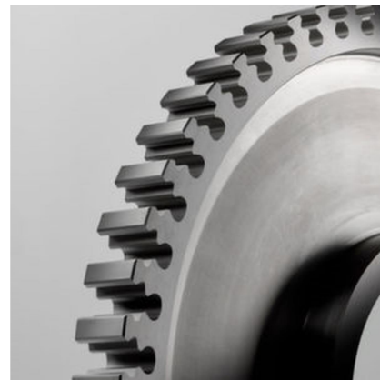
Слика 1.12. Фотографски приказ примера провлакача за спољашње провлачење жљебова специјалне геометрије на диску авио турбине а), и диск авио турбине б) [19]
