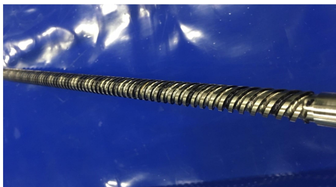
Слика 4.17. Фотографски приказ спиралног међузубља израђеног на „Schneeberger Corvus“
