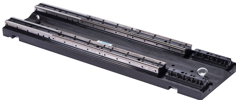
Слика 1.14. Фотографски приказ провлакача за провлачење кочионих чељусти на аутомобилима. [21]
