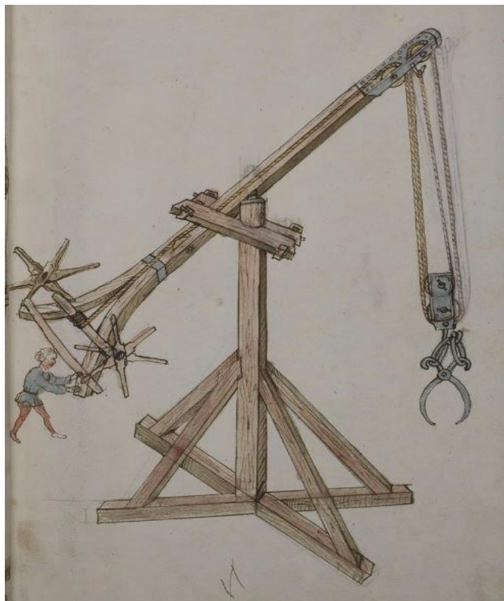
Слика 1.2 Конструктивно решење крана из 15. века [16]
