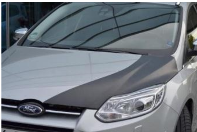
Слика 39: Ford-ов поклопац мотора ојачан угљеничним влакнима [4]
