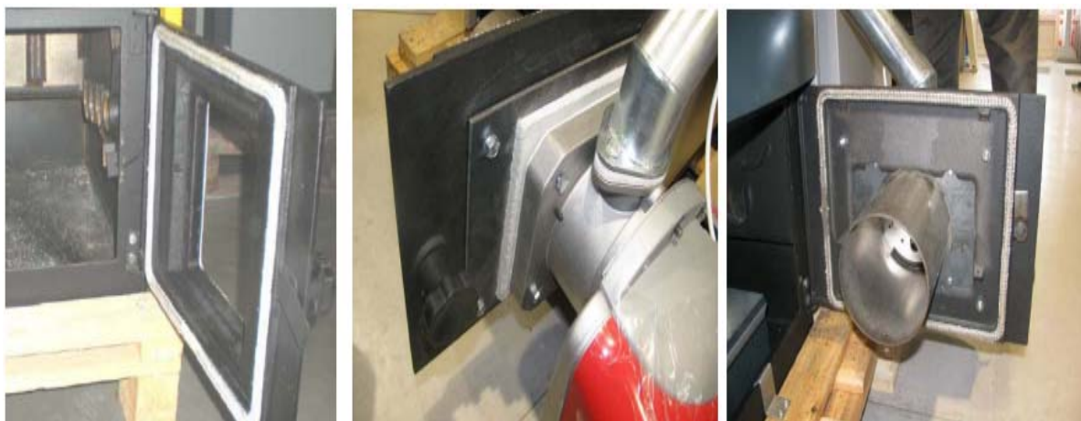
Слика 5.2 Изглед монтираних модификованих врата и инсталираног пелет горионика
