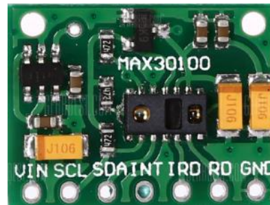
Слика 10: Сензор за мерење кисеоника у крви MAX30100
