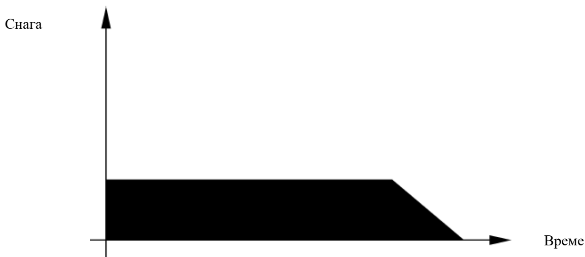
Слика 56. Режим рада континуалног таласа [5]
