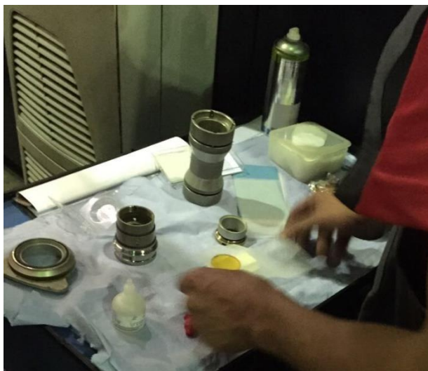
Слика 31. Чишћење сочива (ацетоном) ласера “Trumpf 3040”
