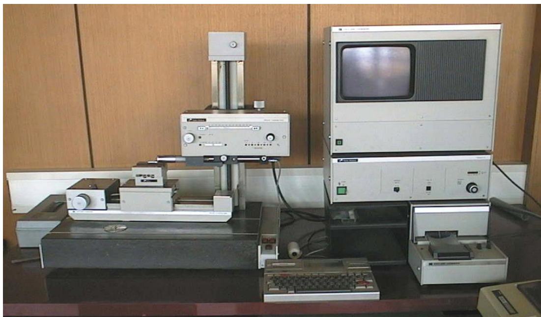
Слика 76. Уређај за мерење храпавости Talysurf на Факултету инжењерских наука, Крагујевац
