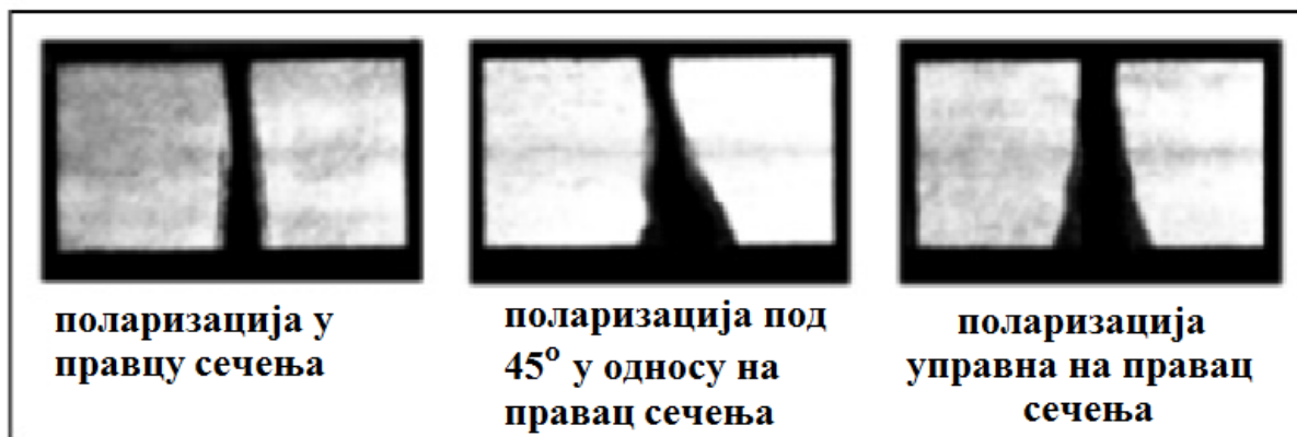
Слика 34. Ефекти сечења ласером за различите правце поларизације у односу на правац реза [6]
