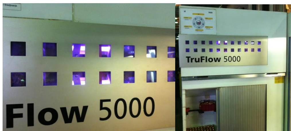
Слика 4. Кућиште у којем се налази резонатор ласера “Trumpf 3040”
