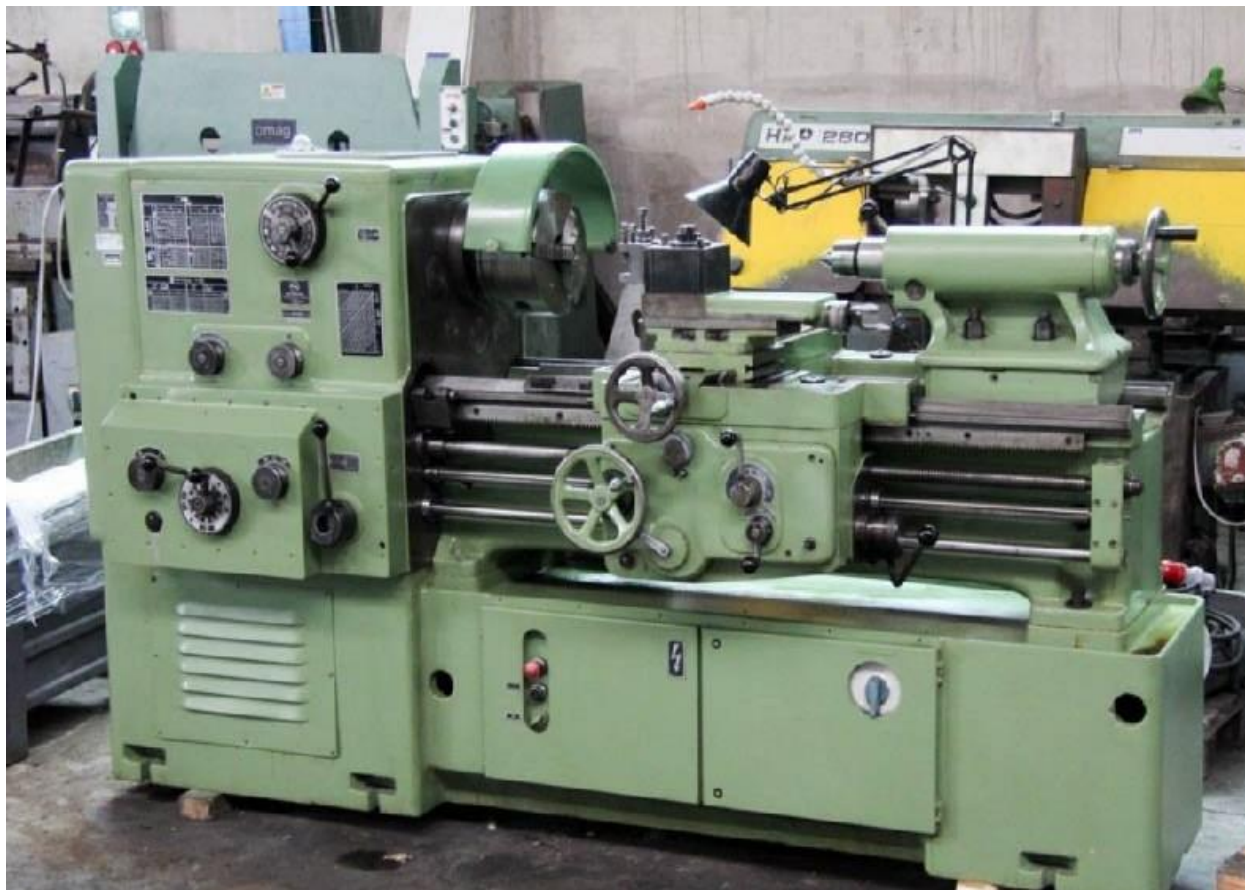
Слика 13. Универзални струг Првوماјска TNP-300 NILES
