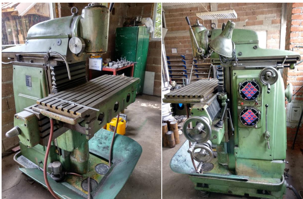
Слика 14. Универзална глодалица Првомајска ALG-200
