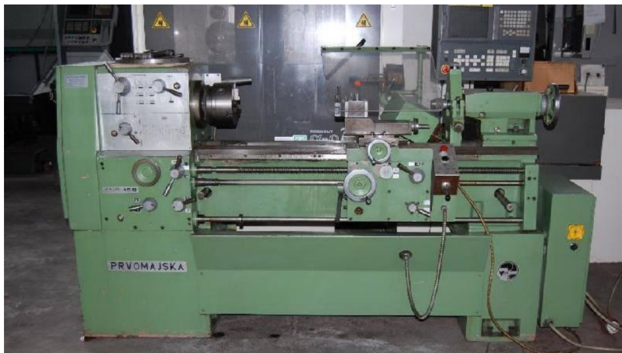
Слика 12. Универзални струг Првوماјска TNP-200B
