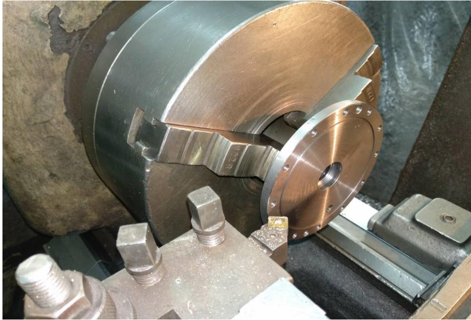
Слика 23. Чеона обрада стругањем
