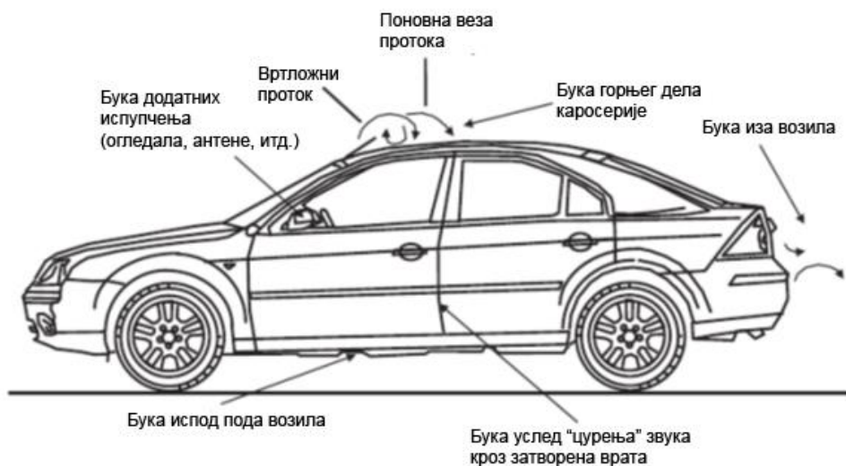
Слика 7 – Основни извори аеродинамичке буке на возилу [8]
