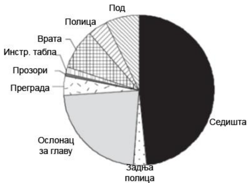
Слика 16 – Апсорпција звука од стране ентеријера возила [7]
