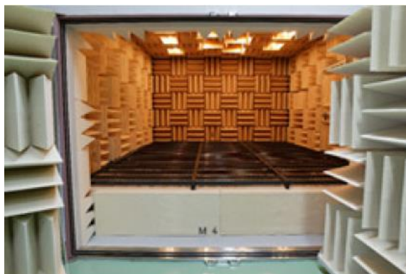
Слика 17 – Анехоишна комора за акустичка мерења
