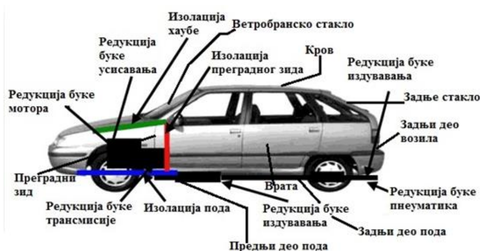
Слика 13 – Основна места погодна за редукцију буке возила [12]
