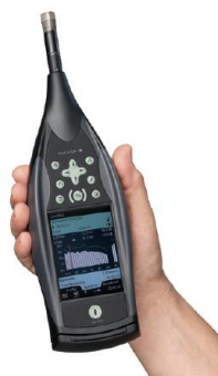
Слика 29 – Савремени фонометри класе 1 према ИЕС 61672-1
