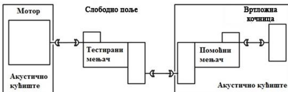
Слика 20 – Пробни сто за испитивање буке у отвореној петљи у слободном пољу [10]
