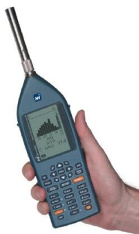
Слика 29 – Савремени фонометри класе 1 према ИЕС 61672-1
