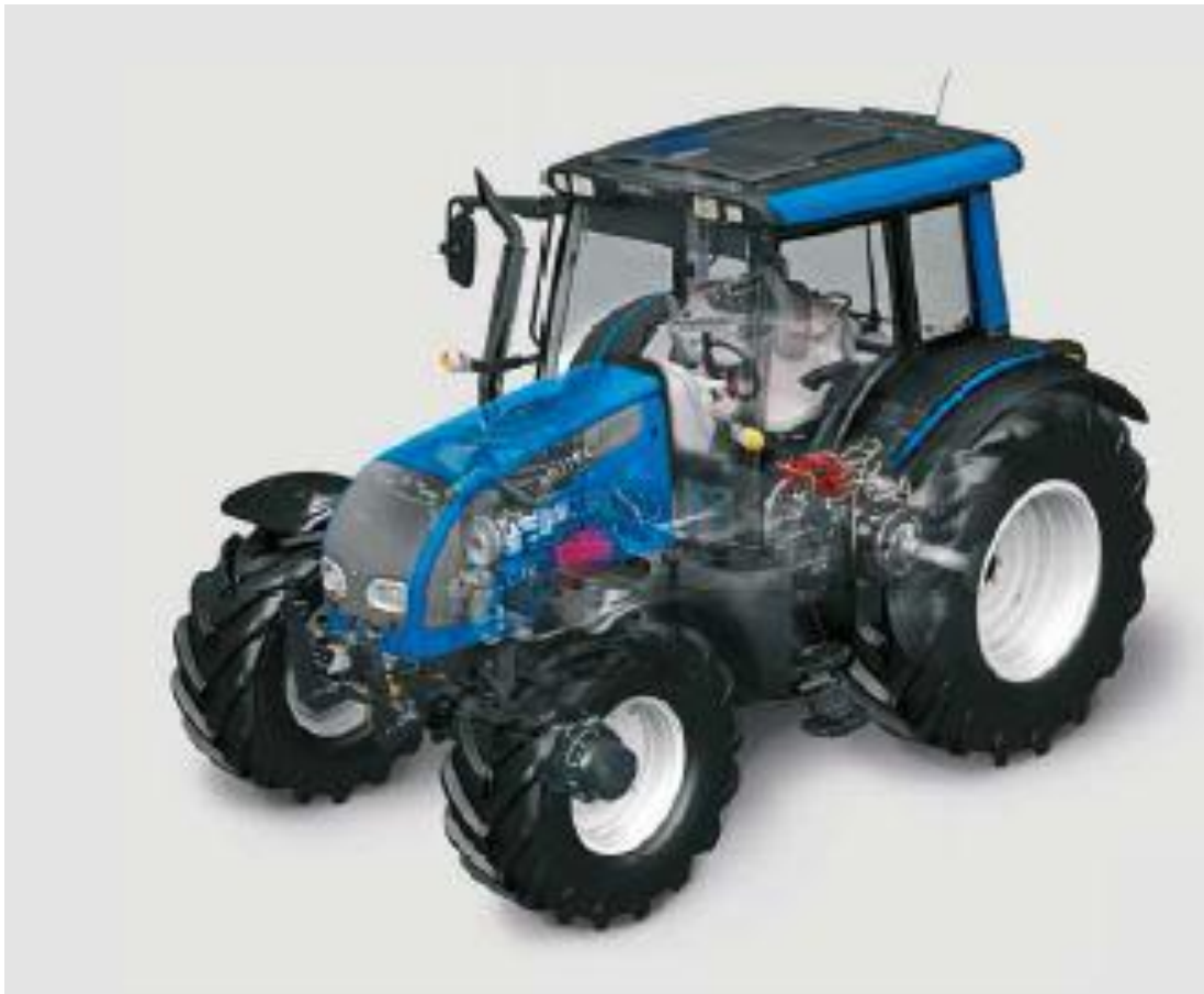
Слика 44-Трактор са хидродинамичком спојницом са константним пуњењем [9]
