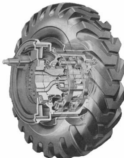
Слика 19- Хидраулични модул мотор – точак [11]
