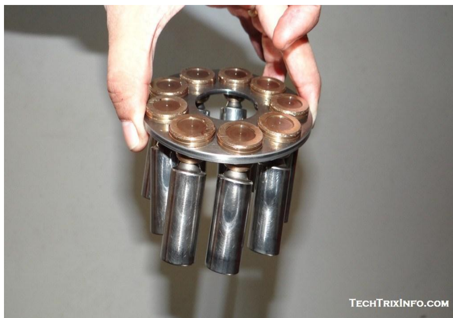
Слика 30 - Похабани клипови клипно аксијалне пумпе [11]
