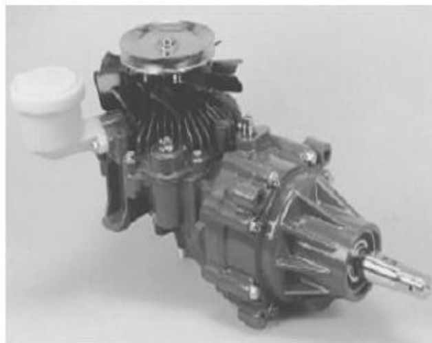
Слика 3- Комбинована хидростатичка трансмисија која спаја регулациону пумпу, регулациони мотор, систем управљања и све остале помоћне компоненте у једно кућиште. Комбинована хидростатичка трансмисија је доступна у различитим варијантама, при чему су многе од њих директно спојене на мотор [3]
