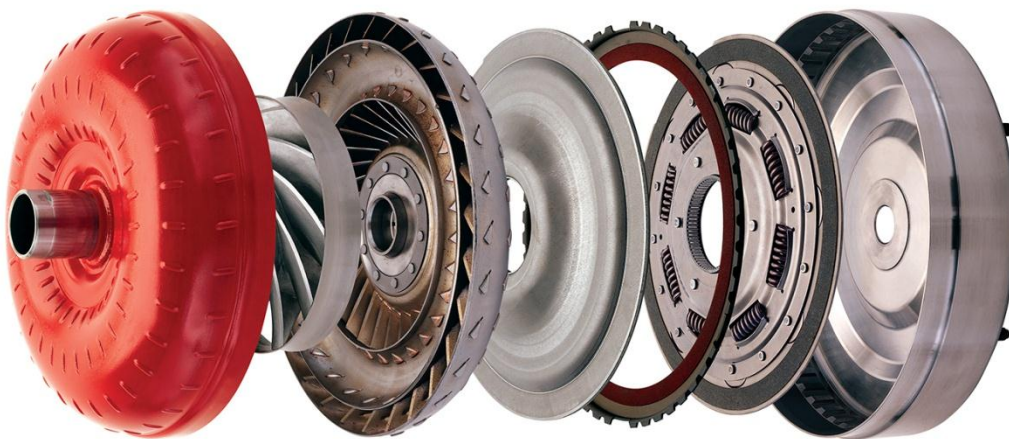
Слика 40 – Приказ делова турбомењача [9]
