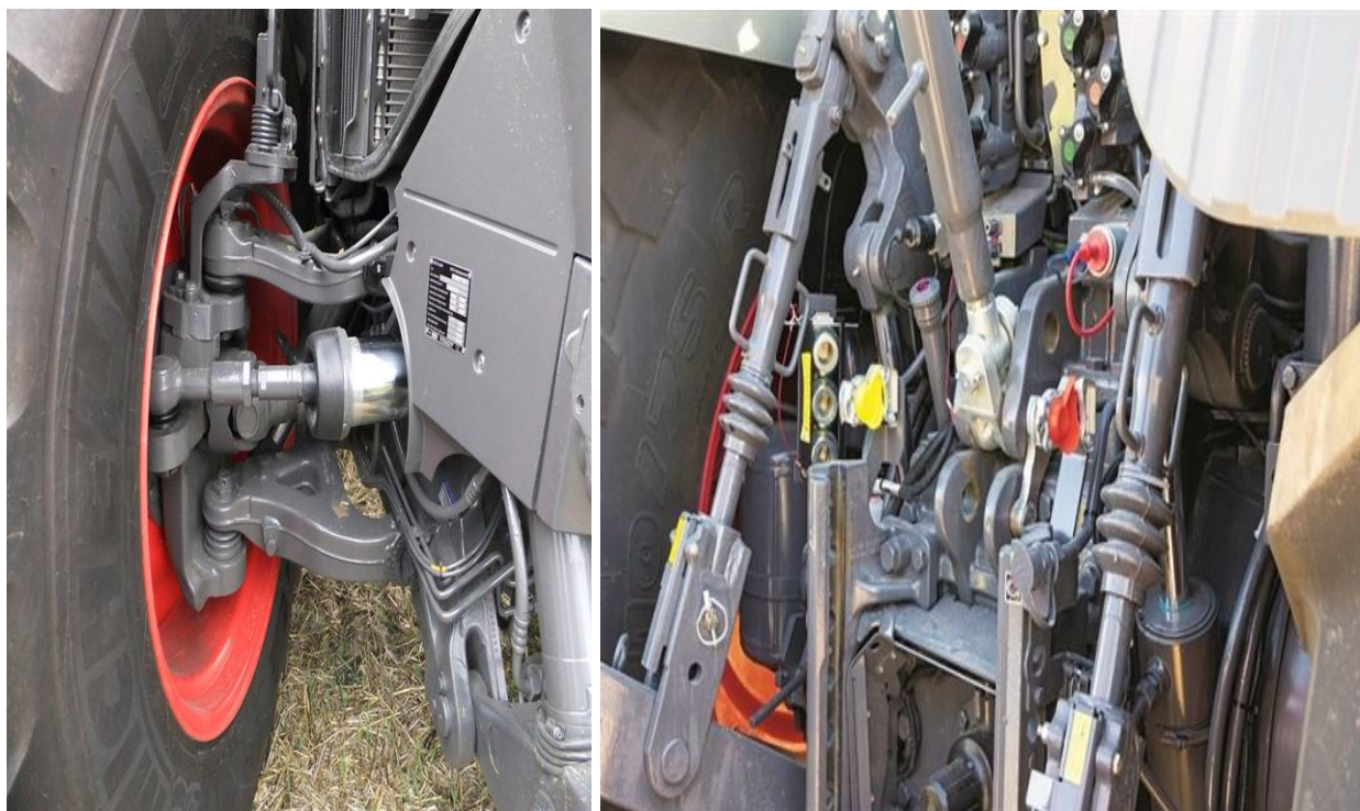
Слика 33 – Коришћење хидраулике за управљање и подизање терета на трактору са задње стране [21]
