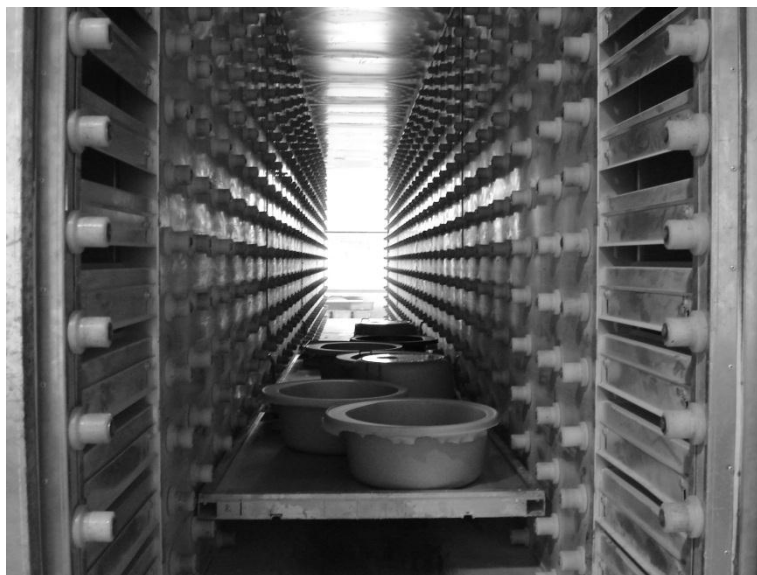
Слика 15. Изглед пећи за печење granmatrix-a
