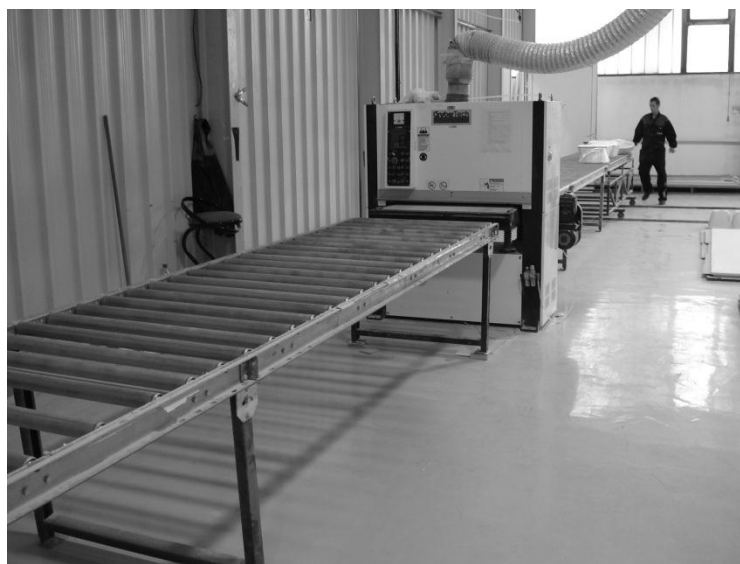
Слика 16. Сендер за калибрисање плоча и површинску дораду.
