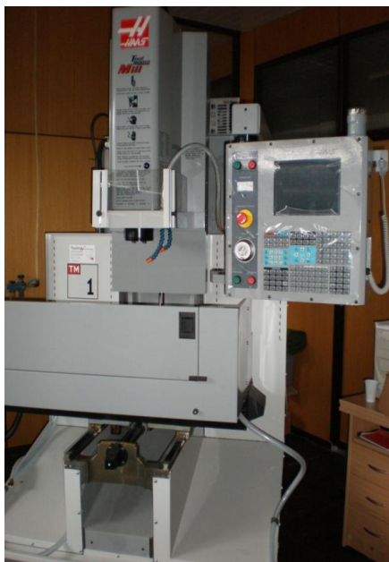
Слика 18. Технички систем HAAS Toolroom Mill TM-1HE , једновретена вертикална глодалица
