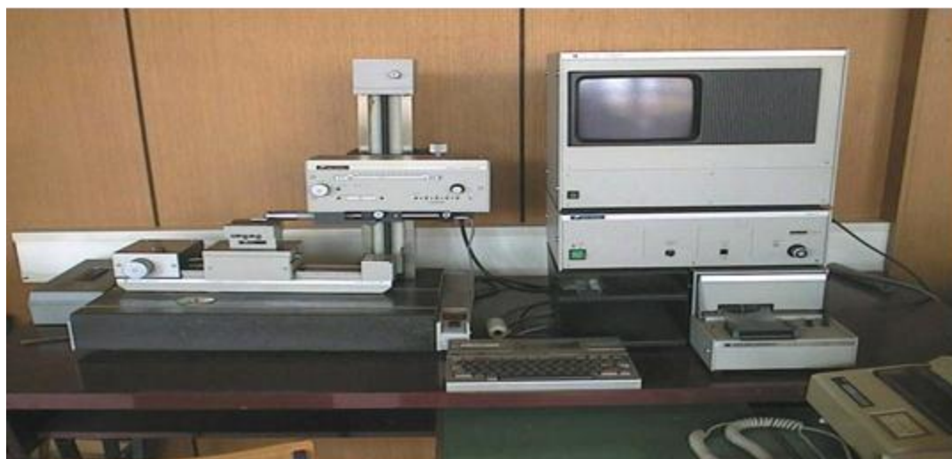
Слика 19. Уређај за мерење храпавости Talysurf 6 . [11]
