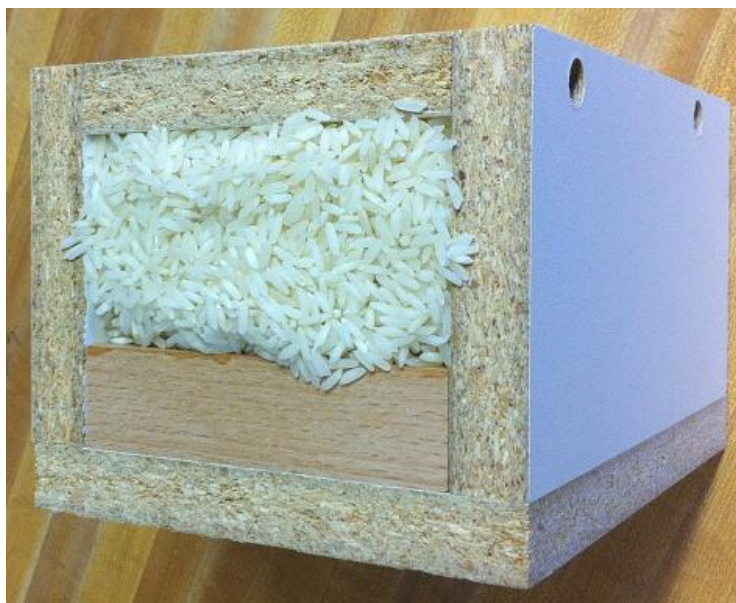
Слика 8. Мерење запремине шупљине [5]
