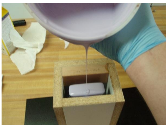
Слика 10. Испуњавање калупне шупљине [5]
