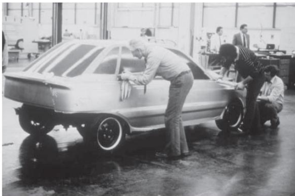
Слика 3.17. Фарбање модела од глине
