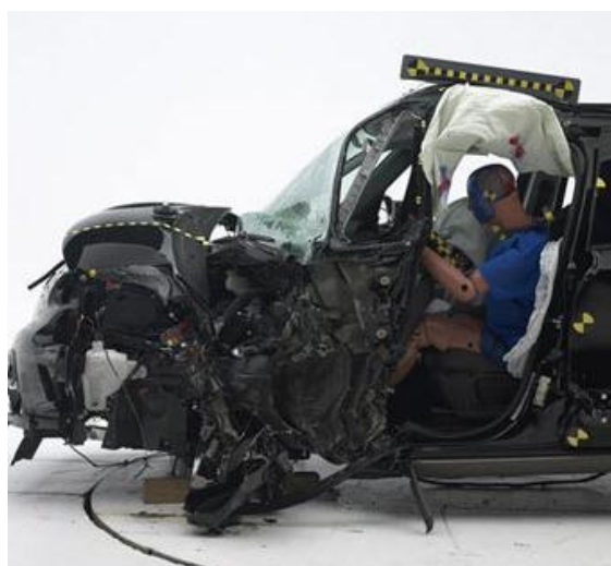
Слика 3.30. Изглед кабине после тестирања
