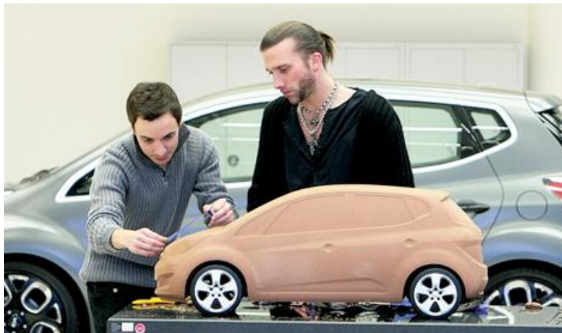
Слика 1.3. Израда умањеног модела
