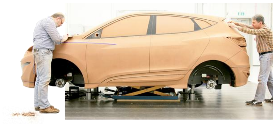
Слика 1.6. Израда реалног модела од глине
