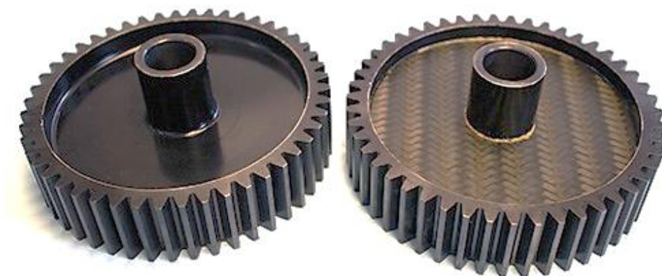
Слика 2.6 - Цилиндрични зупчаник израђен од метала (лево) и композита (десно), [11]
