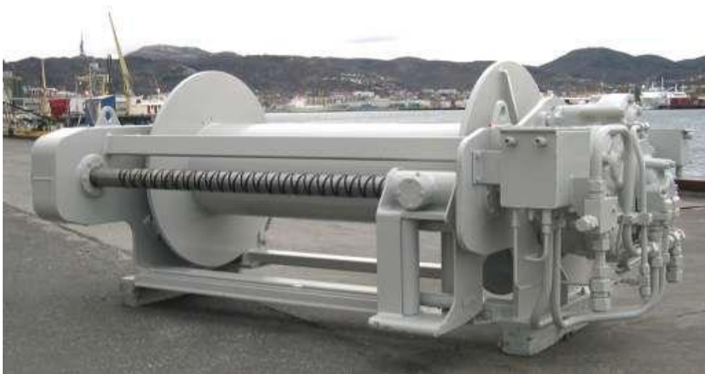
Слика 37. Витло са хидрауличним погоном за океанографска истраживања
