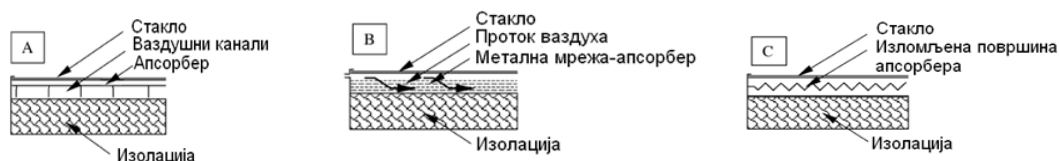
Слика 4.11 Најчешћа конструкцијска решења апсорбера застакљеног ваздушног соларног колектора [5] [14]
