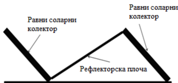
Слика 4.13 Равни соларни колектори са рефлекторском плочом између њих [5] [14]
