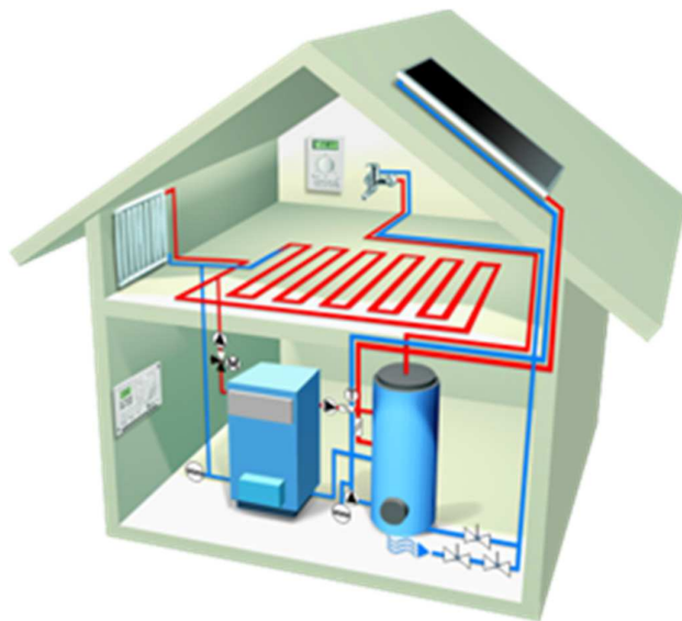
Слика 3.6 Активни водени соларни систем за загревање просторија [15]
