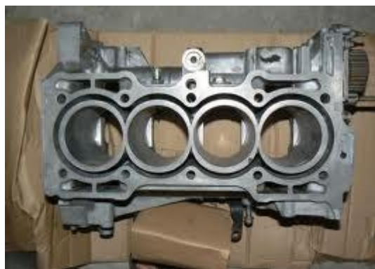
Слика 10. Ливени блок мотора од алуминијума [4]
