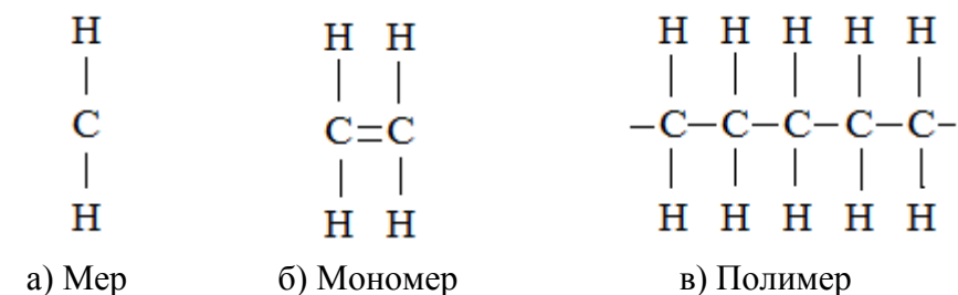
Слика 9.4 Структурне формуле а) мера, б) мономера, в) полимера
