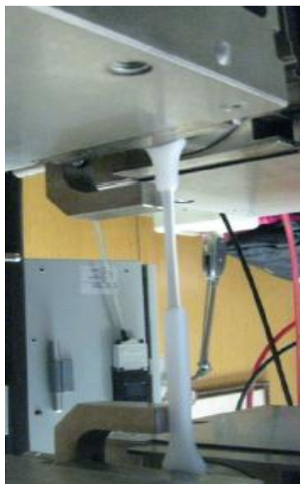
Слика 10.3. Епрувета при затезању
