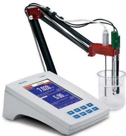
Слика 6. Лабораторијски рН-метар [3]
