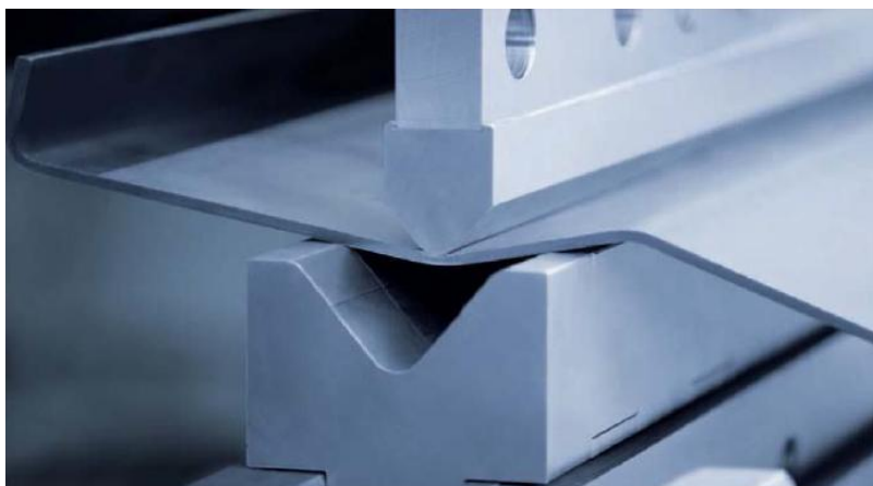
Слика 1 - Алат на преси за профилно савијање у захвату (детал)
