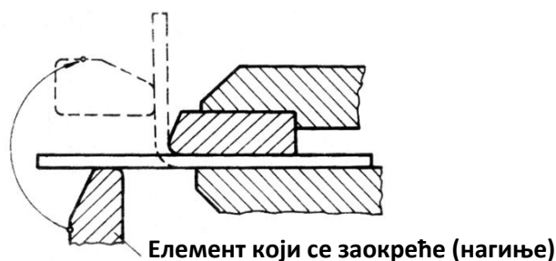
Слика 36 - Принцип рада машине за пресавијање
