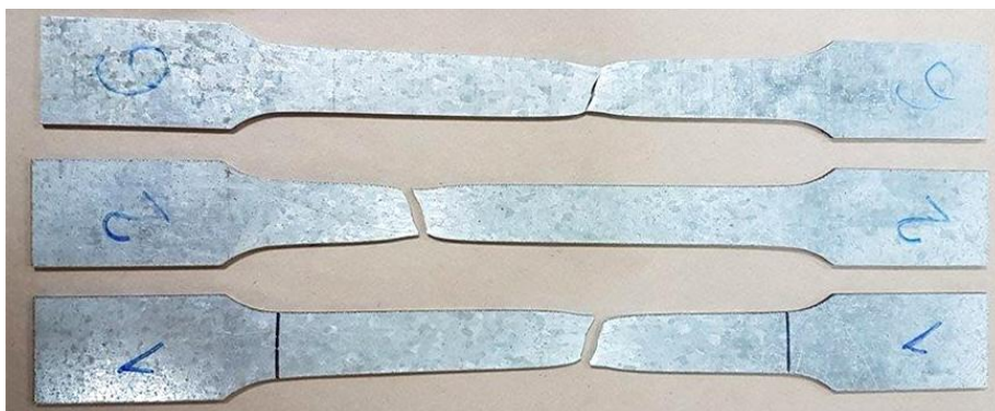
Слика 44 - Изглед епрувета након одређивања механичких карактеристика материјала
