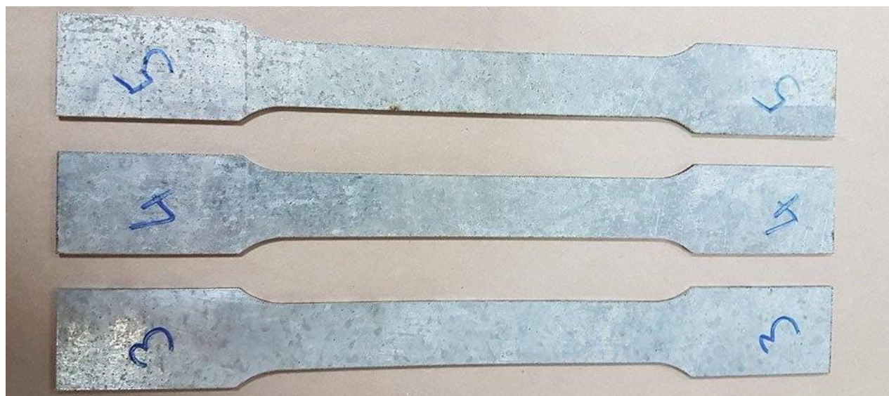
Слика 43 - Изглед епрувета за одређивање механичких карактеристика материјала
