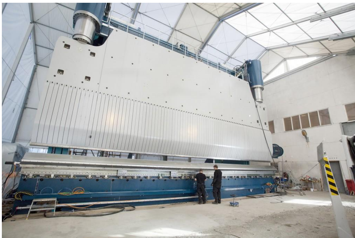
Слика 39 - Абкант преса носивости 4000t, радне дужине 14 метара
