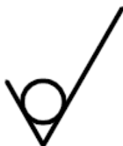
Слика 17. Основна кукица са додатком кружића (допуштено уклањање материјала)
