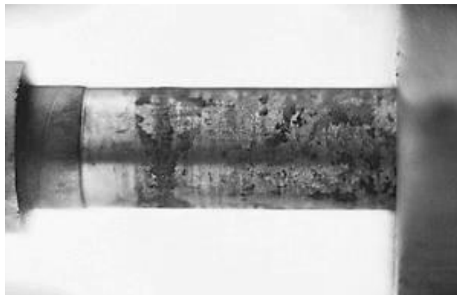
Slika 53: Fretting korozija osovine
