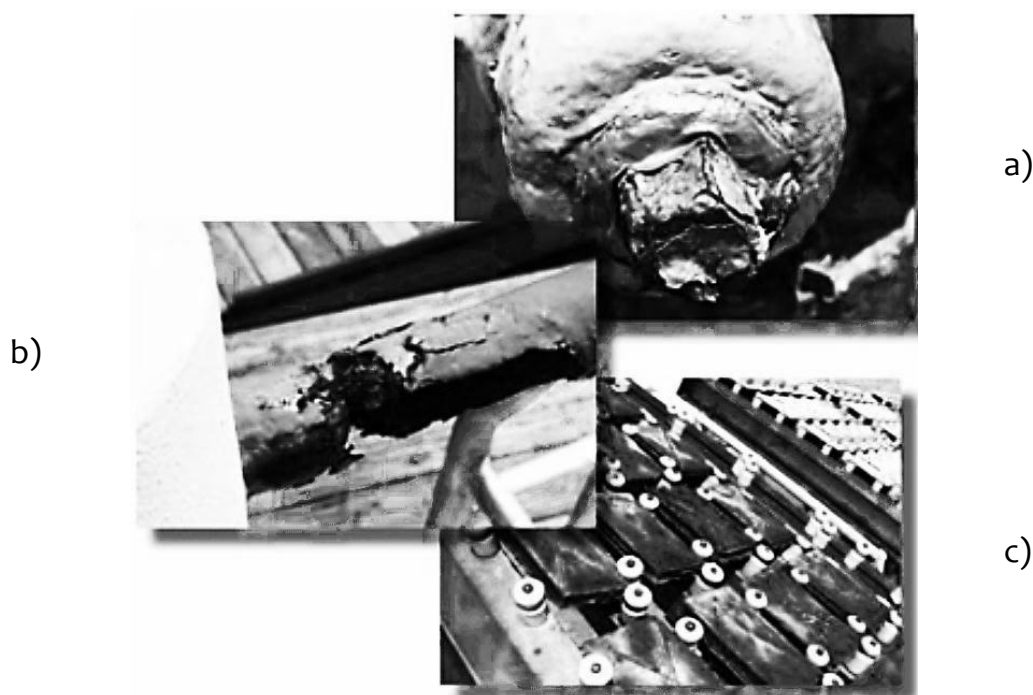
Slika 68: Korozija u svemiru: a) korozija zavrtnja i navrtke svemirskog broda, b) korozija dela stuba nosača solarnog panela svemirskog broda, c) korozija elemenata solarnog panela telekomunikacionog satelita [28]
