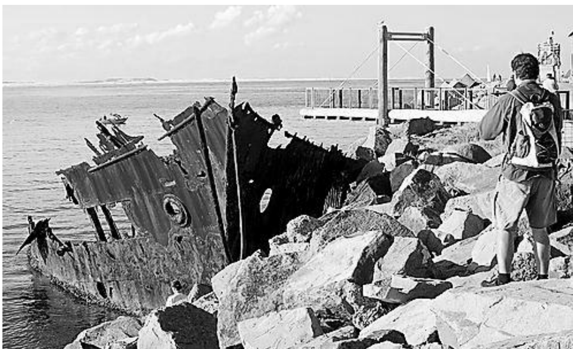
Slika 42: Korozija broda u morskoj vodi
