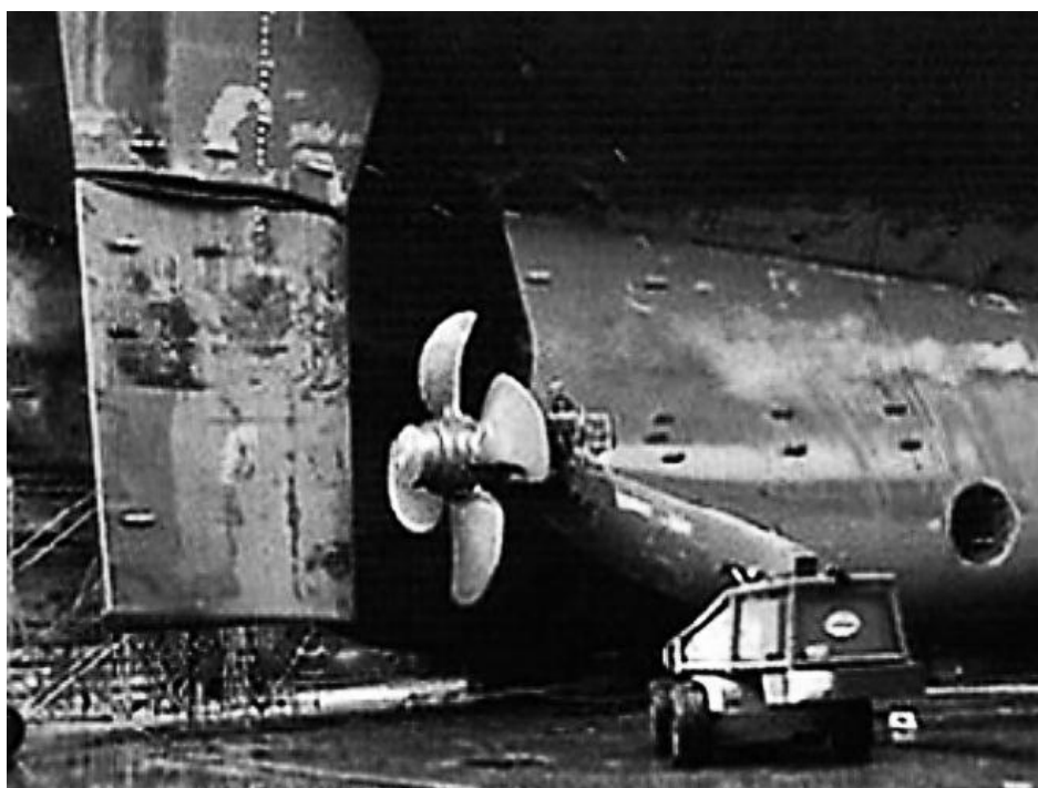
Slika 72: Protekorna zaštita: a) list kormila prekookeanskog broda sa cink anodama, b) list kormila i deo trupa tankera sa cink anodama [28]
