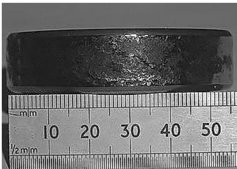
Slika 52: Fretting korozija kugličnog ležaja
