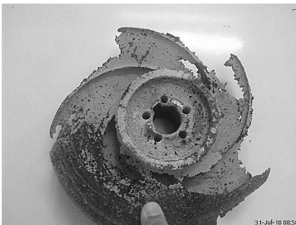
Slika 6o: Kavitaciona korozija: a) kavitaciona korozija radnog kola pumpe, b) kavitaciona korozija radnog kola pumpe većeg stepena
