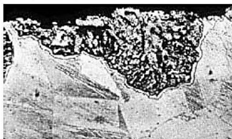
Slika 63 : Selektivna korozija mesinga: a) šematski prikaz selektivne korozije mesinga, b) - d) primeri selektivne korozije mesinga
