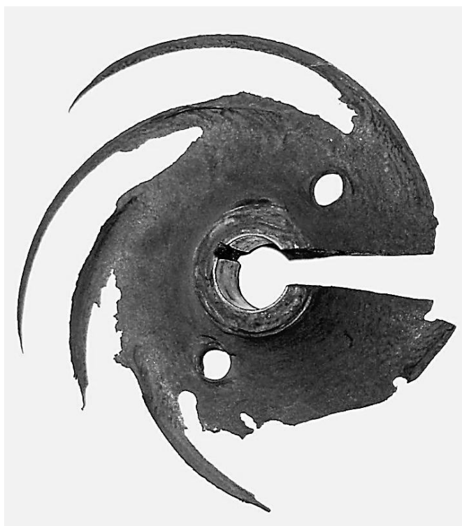
Slika 59: Kavitaciona korozija: a) kavitaciona korozija brodskog propelera manjeg stepena, b) kavitaciona korozija brodskog propelera većeg stepena [27]
