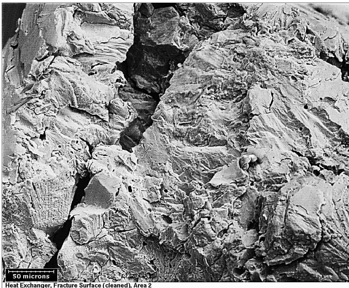
Slika 24: Primer zamorne korozije cevi izmenjivača toplote na elektronskom mikroskopu
