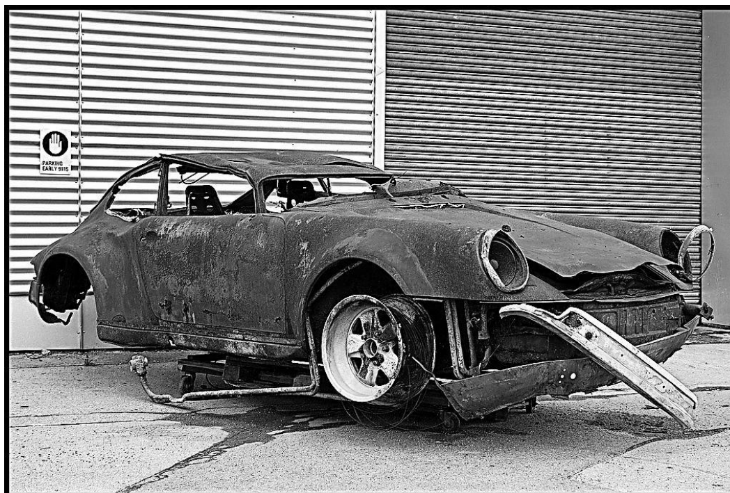
Slika 34: Atmosferska korozija automobila
